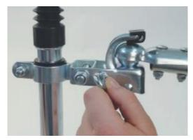
Ziehen Sie die Sicherheits-Schraube an, damit die Ziehstange während der Fahrt an Ort und Stelle bleibt.
