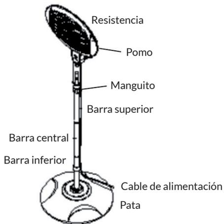
Conecte la resistencia (1) a la varilla superior (7), apriétela girando el pomo. Pase el cable de alimentación por la abrazadera.
