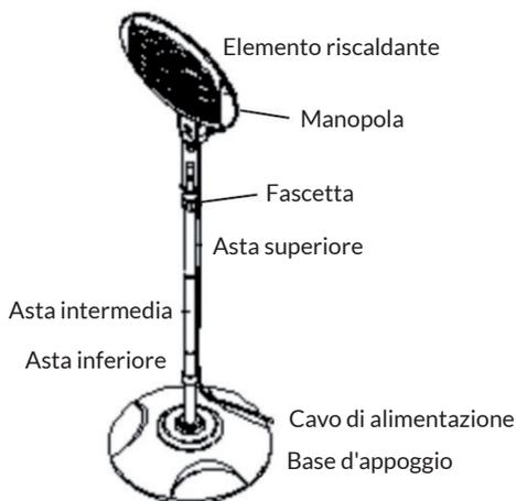
Collegare l'elemento riscaldante (1) all'asta superiore (7) e fissarlo girando la manopola. Far passare il cavo di alimentazione attraverso il morsetto.
