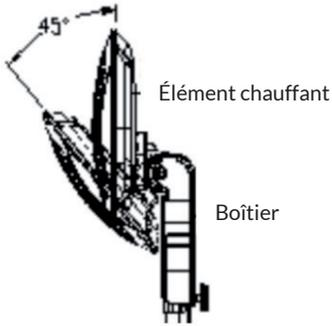
Selon les besoins, l'angle de l'élément chauffant peut être réglé de 0 à 45 degrés.
