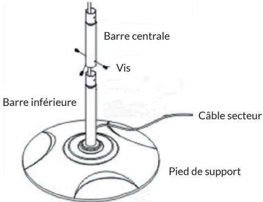
Insérez la barre centrale (9) dans la barre inférieure (11) et fixez la barre avec une vis cruciforme.
