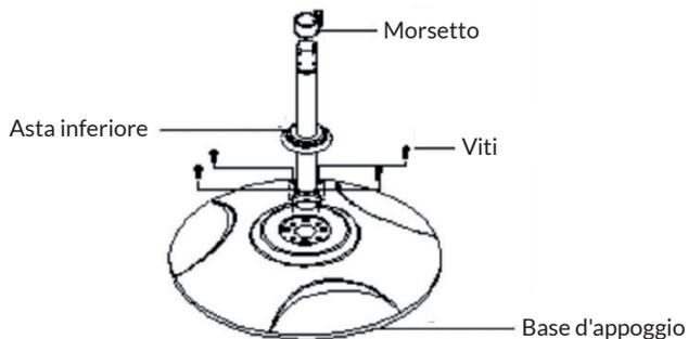
Inserire l'asta inferiore (11) nella base d'appoggio (16) e fissarla saldamente con una vite a croce.
