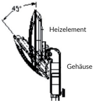
Je nach Bedarf kann der Winkel des Heizelements auf einen Winkel von 0-45 Grad eingestellt werden.
