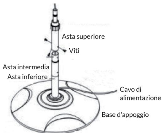
Inserire l'asta superiore (7) nell'asta intermedia (9) e fissarla con una vite a croce.
