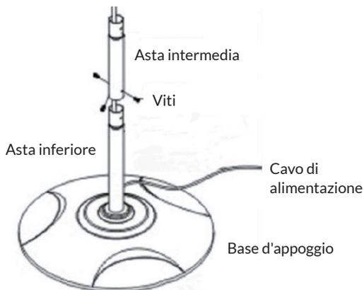
Inserire l'asta centrale (9) nell'asta inferiore (11) e fissarla con una vite a croce.
