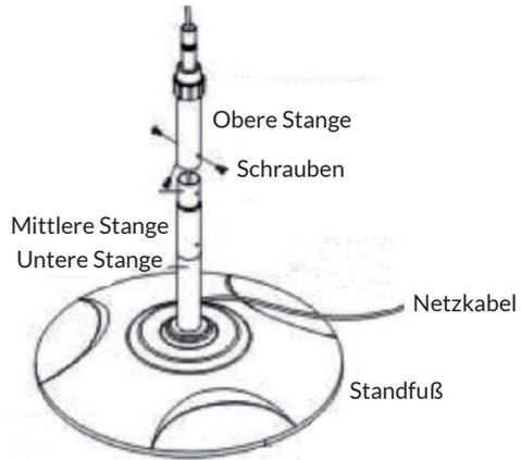
Stecken Sie die obere Stange (7) auf die mittlere Stange (9) und schrauben Sie die Stange mit einer Kreuzschlitz- schraube zusammen.
