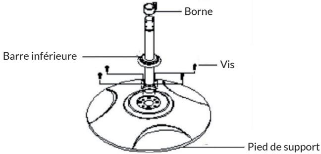
Insérez la barre inférieure (11) dans le pied (16) et fixez-la à l'aide d'une vis cruciforme.
