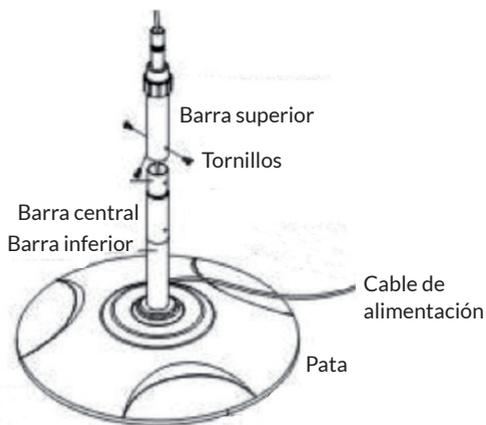
Coloque la barra superior (7) sobre la barra central (9) y atornille la barra con un tornillo Phillips.
