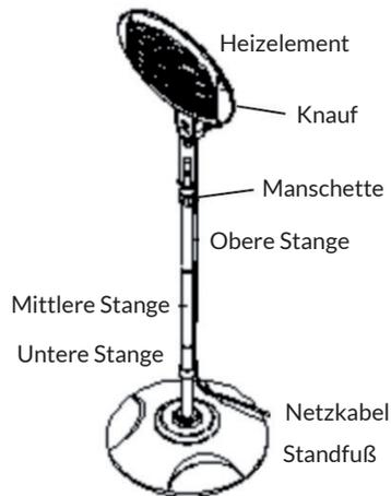
Verbinden Sie das Heizelement (1) mit der oberen Stange (7), ziehen Sie sie fest, indem Sie den Knauf drehen. Führen Sie das Netzkabel durch die Klemme.
