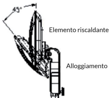
A seconda delle necessità, l'inclinazione dell'elemento riscaldante può essere regolata su un angolo di 0-45 gradi.
