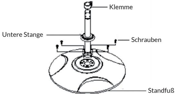
Führen Sie die untere Stange (11) in den Standfuß (16) und ziehen Sie ihn mit einer Kreuzschlitzschraube fest.
