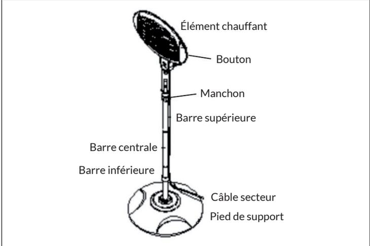
Reliez l'élément chauffant (1) à la barre supérieure (7), serrez-la en tournant le bouton. Passez le câble d'alimentation dans la borne.
