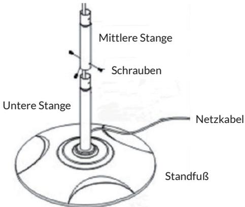
Stecken Sie die mittlere Stange (9) in die untere Stange (11) und befestigen Sie die Stange mit einer Kreuzschlitzschraube.
