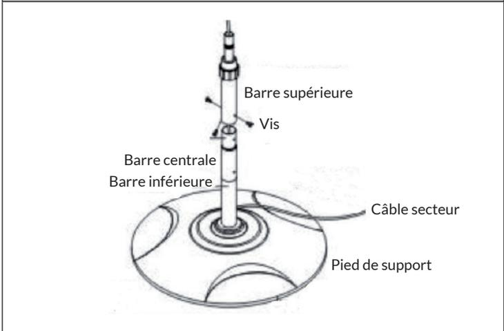
Insérez la barre supérieure (7) dans la barre centrale (9) et fixez la barre avec une vis cruciforme.
