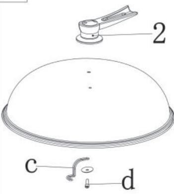
Montieren Sie den Griff (1) in die Grillhaube mit der Schraube (e), der Dichtung (d) und dem Haken (c). Dann stellen Sie die Grillhaube auf die Grillplatte.
