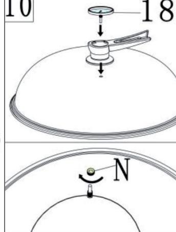
Führen Sie das Thermometer (18) in das Loch der Grillhaube und verschrauben Sie es auf der Rückseite der Haube mit der einer Schraube und der Mutter (N).
