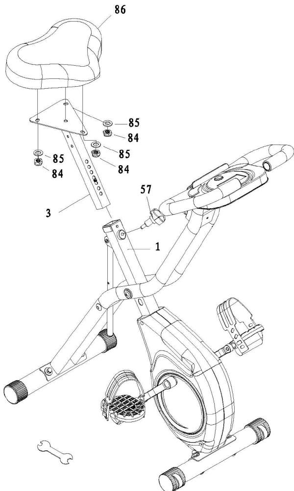
Monter la selle (86) sur le support de selle (5) et assurer l'attache avec 3 écrous en nylon (84).
