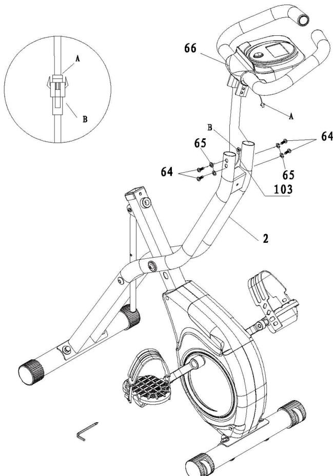
Fixer la console d'entraînement à l'avant de l'appareil (2) et la fixer avec 4 vis à six pans creux (66) et les rondelles correspondantes (65).
