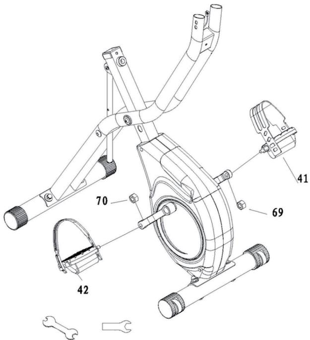
Montieren Sie die Pedale (41 & 42) an den Kurbeln und fixieren Sie mit den Kontermuttern (69 & 70).
