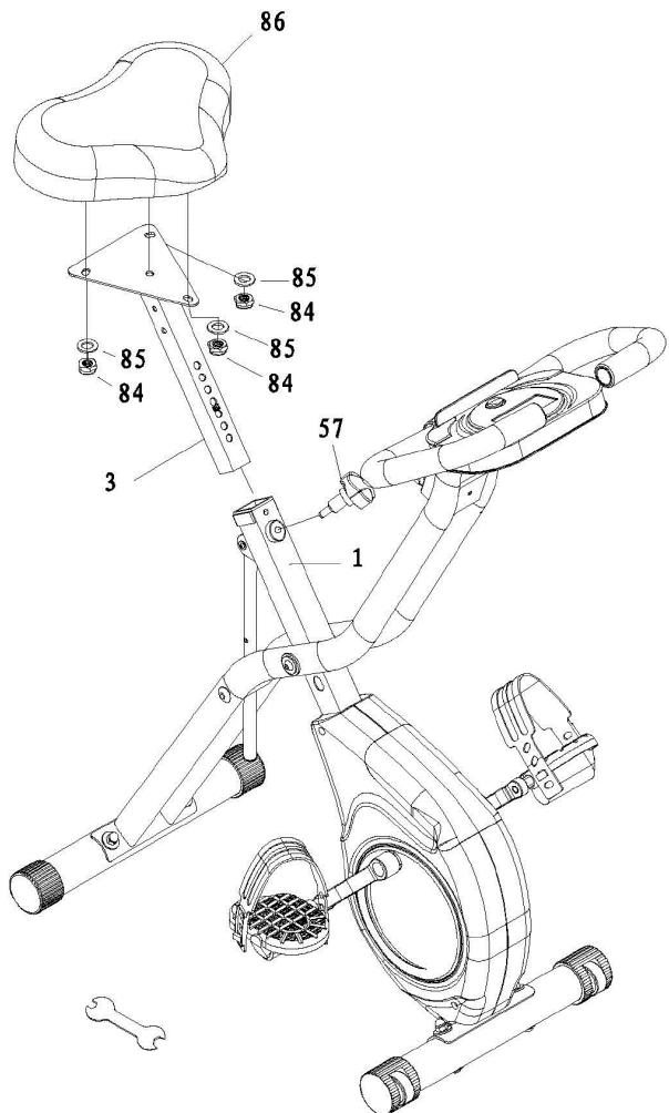
Montieren Sie den Sattel (86) auf der Sattelstütze (5) und sichern Sie die Verbindung mit 3 Nylon-Muttern (84).
