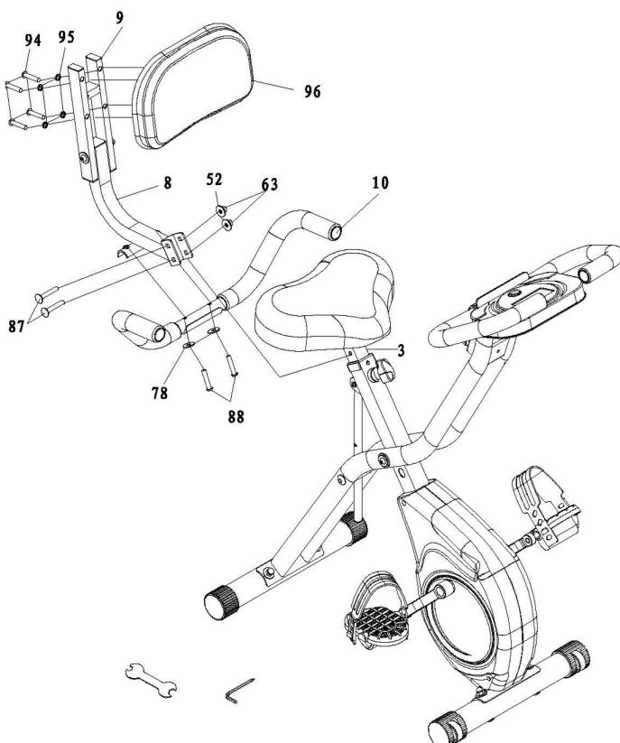
Bringen Sie die Rückenlehne (96) an der Halterung (9) an und verschrauben Sie mit 4 Inbusschrauben (94) und entsprechenden gewölbten Unterlegscheiben (95).
