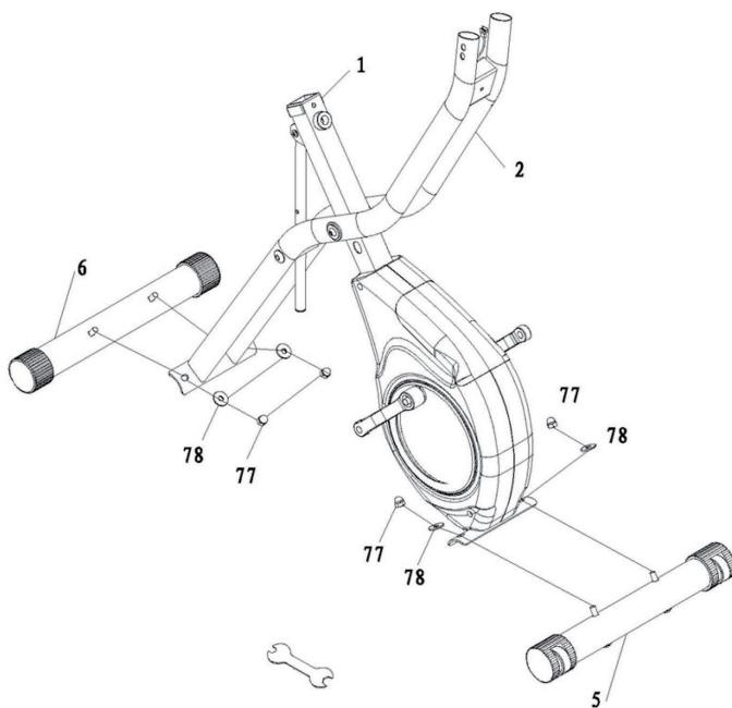
Montieren Sie die Füße (5 & 6) am Rahmen (1). Nutzen Sie dazu die gewölbten Unterlegscheiben (78) und die Hutmuttern (77).
