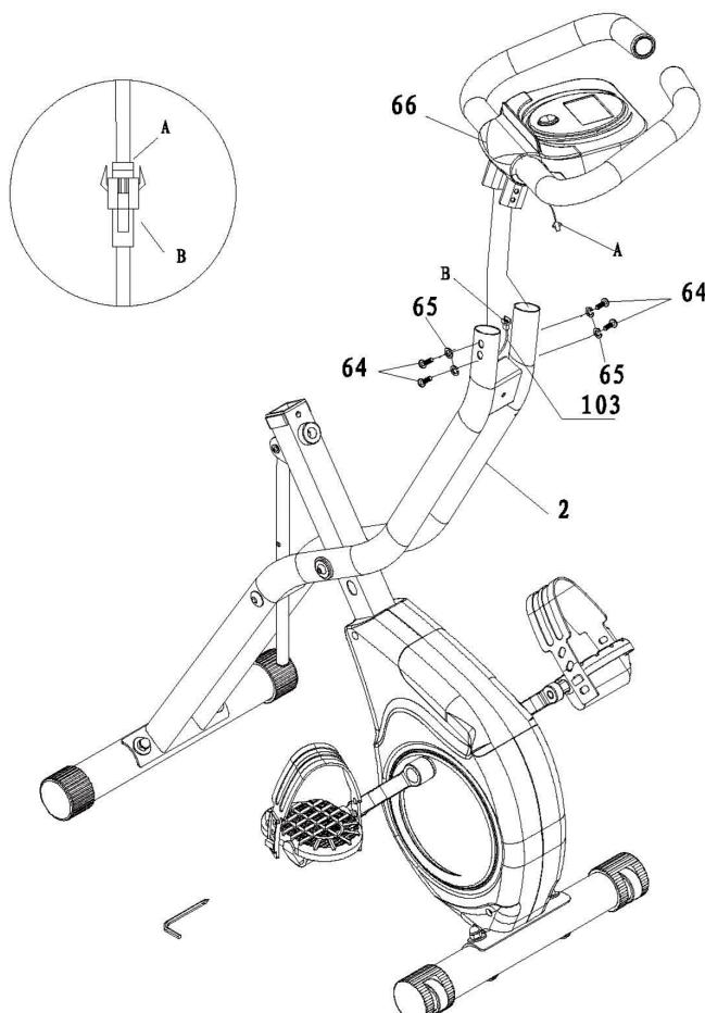
Monte el ordenador de entrenamiento en la parte delantera (2) y asegúrelo con 4 tornillos Allen (66) y las arandelas correspondientes (65).
