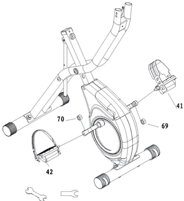
Monter les pédales (41 & 42) sur les manivelles et les fixer avec les contre-écrous (69 & 70).
