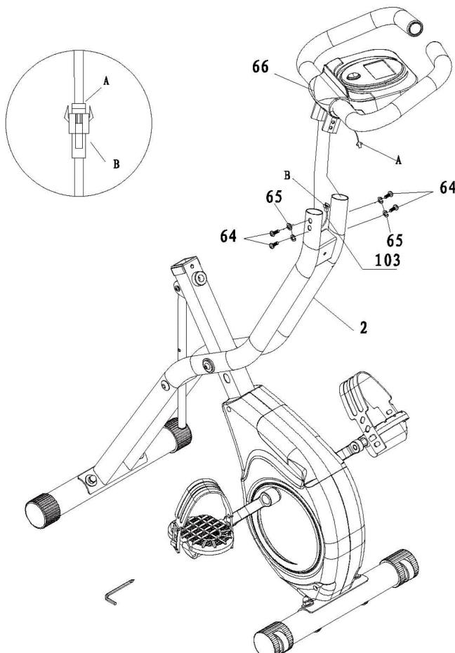
Montare il computer di allenamento sulla parte frontale (2) e fissarlo con 4 viti a brugola (66) e le relative rondelle (65).
