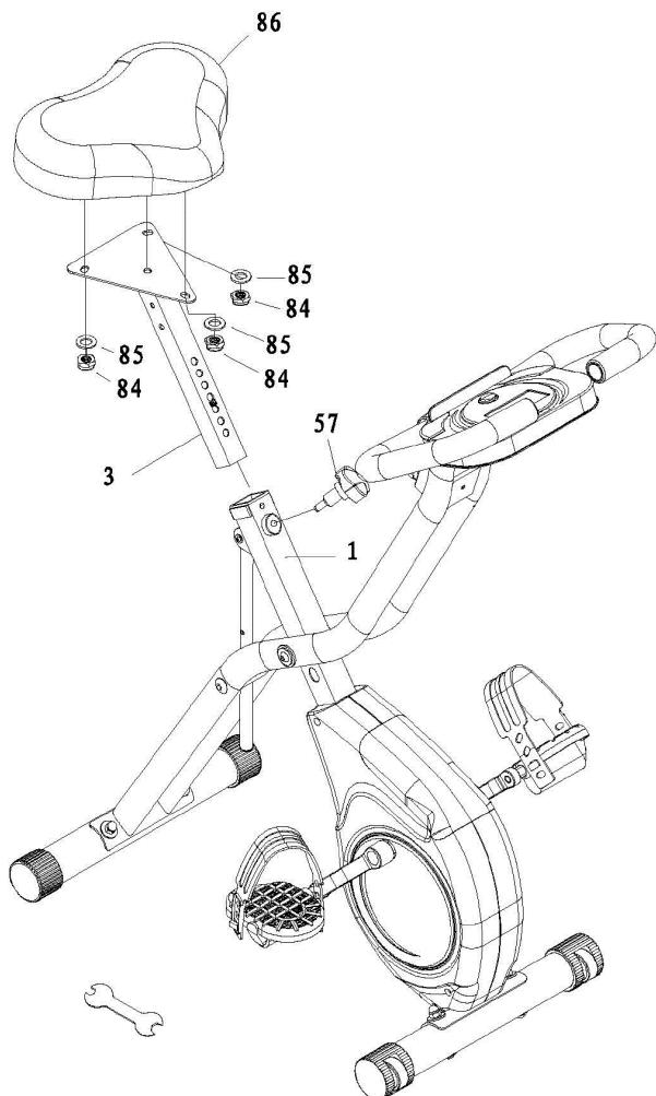
Montare la sella (86) sul suo supporto (5) e fissare il collegamento con 3 dadi in nylon (84).
