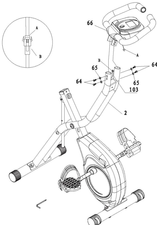
Montieren Sie den Trainingscomputer an der Front (2) und sichern Sie mit 4 Inbusschrauben (66) und entsprechenden Unterlegscheiben (65).
