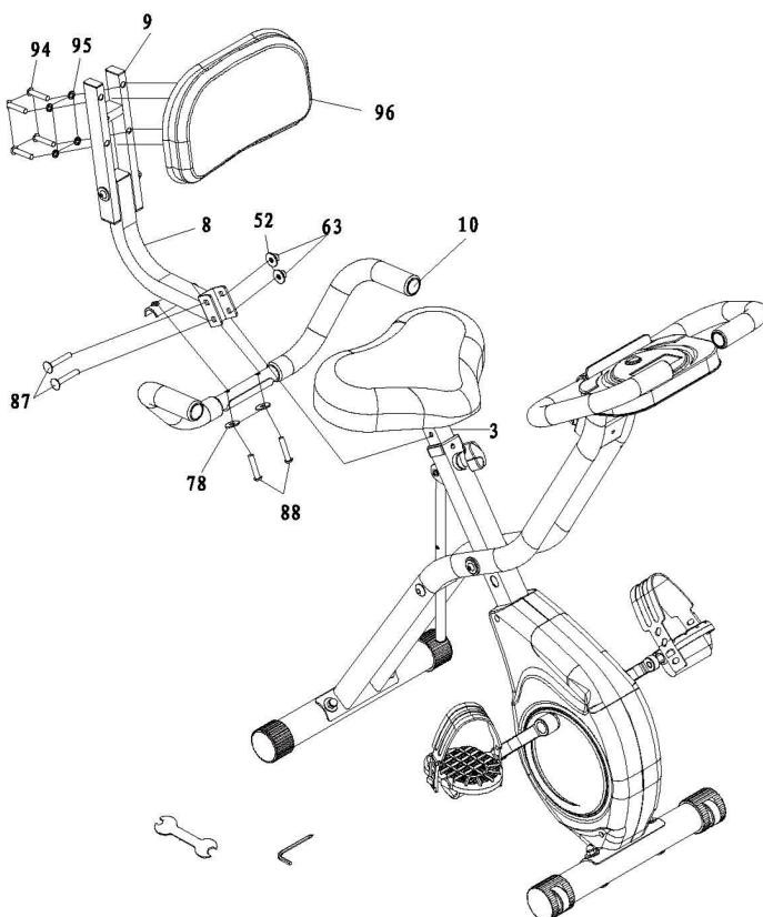
Montare lo schienale (96) sul supporto (9) e avvitare con 4 viti a brugola (94) e le relative rondelle curve (95).
