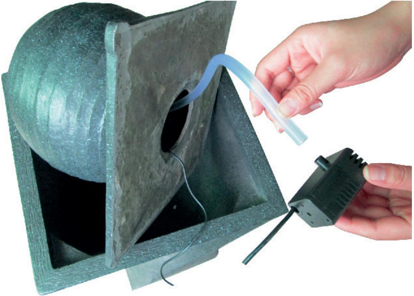
Faire sortir le câble d'un des côtés du socle et installer le panneau solaire à proximité. Raccorder le conduit d'eau à la pompe comme sur l'image ci-dessus.
