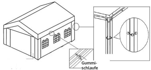
6. Spannen Sie an jeder Ecke ein Abspannseil. Befestigen Sie die Abspannseile jeweils mit einem Erdnagel (8x300 mm).
