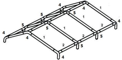
2. Bocken Sie eine Seite auf und stecken Sie die Fußrohre (3) in die Eckverbinder (4) und Mittelverbinder (5) hinein.
