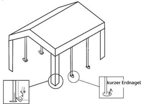
5. Breiten Sie die Planen für die Seiten und die Tür aus. Verbinden Sie die Planen am Gestänge, indem Sie die Gummischlaufen durch die Ösen an den Seitenplanen und der Türplane ziehen, um Stabilität zu sicherzustellen. Benutzen Sie zur Befestigung der Tür auch die kurzen Erdnägeln am Boden.
