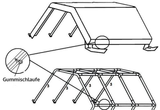
4. Stecken Sie die anderen vier FüÙe (3) in die Eckverbinder und Mittelverbinder (4,5). Stellen Sie auf diese Weise die Konstruktion fertig. Befestigen Sie die FüÙe mit den Erdnägeln (6x180 mm). Befestigen Sie die Blenden für die Eckstandrohre mit den Haken am Boden.
