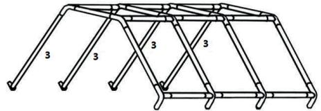
3. Ziehen Sie nun die Dachplane über den Dachrahmen. Befestigen Sie die Dachplane mit den Gummischlaufen. Ziehen Sie dazu immer den Gummiball durch eine Schlaufe und lassen ihn los. Achten Sie auf Spannung der Schlaufen. Wenn Sie auf einer Seite zu viele verwenden, kann es auf der anderen Seite zu schwer werden, die Schlaufen festzuziehen.
