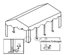
5. Breiten Sie die Planen für die Seiten und die Tür aus. Verbinden Sie die Planen am Gestänge, indem Sie die Gummschlaufen durch die Ösen an den Seitenplanen und der Türplane ziehen, um Stabilität zu sicherzustellen. Benutzen Sie zur Befestigung der Tür auch die kurzen Erdnägel am Boden.
