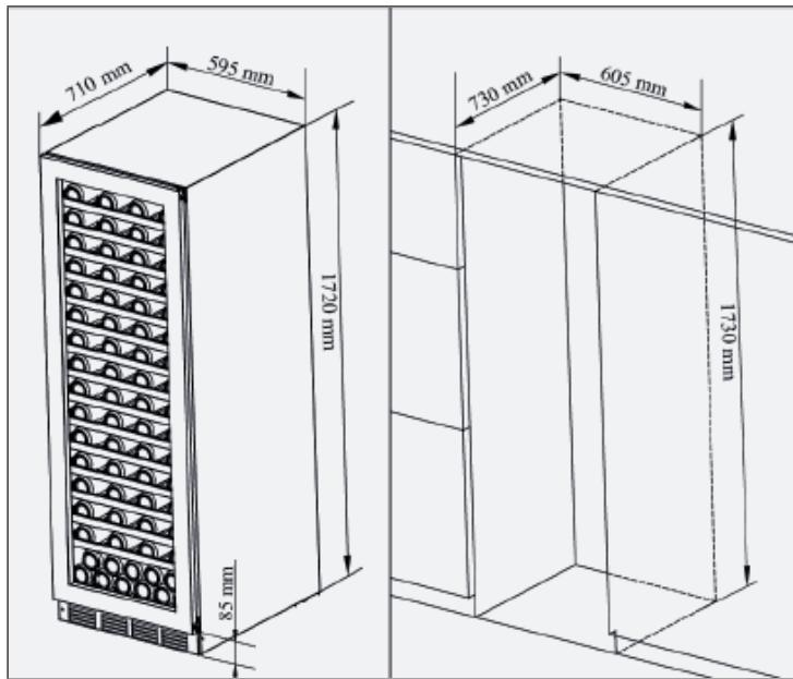
Desembale el aparato y retire todas las bandas adhesivas y de transporte del embalaje. El aparato debe colocarse de tal manera que el enchufe sea fácilmente accesible. Quite el cable de alimentación. Coloque la vinoteca en la posición final. El compresor no puede estar en contacto con otros objetos.
