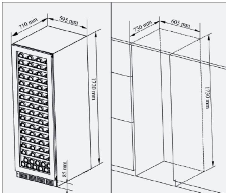
Sortir l'appareil de l'emballage et retirer toutes les bandes adhésives de l'appareil ainsi que les protections pour le transport. Installer l'appareil de sorte à ce que la prise électrique soit facilement accessible. Ne pas encombrer le cordon d'alimentation. Mettre le réfrigérateur à vin dans la position prévue. Le compresseur ne doit toucher aucun objet.
