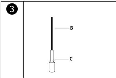
Setzen Sie den Stab der Wasserstandsanzeige auf den Schwimmer.
