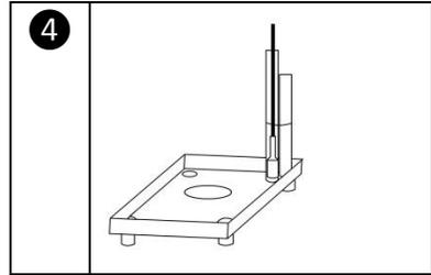
Stecken Sie die Hülse der Wasserstandsanzeige darüber.
