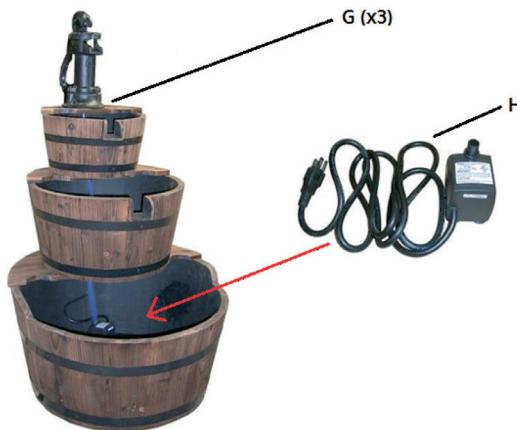
Montez la pompe manuelle sur le dessus du petit tonneau et vissez-la au tonneau avec les 3 vis à bois (G) (utilisez les trous pré-percés pour l'orientation). Placez la pompe (H) dans le grand tonneau et faites passer le câble d'alimentation à l'extérieur. Versez suffisamment d'eau fraîche dans le tonneau (environ à moitié plein). Branchez le tuyau d'eau sur la valve de la pompe. Branchez la fiche secteur sur une prise de courant. La pompe commence à fonctionner après un court instant.
