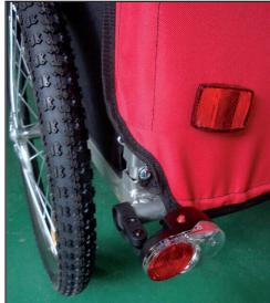
Inserte el mástil del banderín en el orificio del lateral y apriételo.
