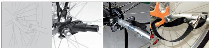
**Importante:** el enganche entre la bicicleta y el remolque es la parte más importante del montaje. Asegúrese de que el remolque esté bien acoplado a la bicicleta.
