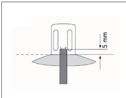
L'ouverture de la mèche doit être complètement étanche. Grâce à l'effet purement capillaire de la mèche fournie, celle-ci ne se consume pas et n'a pas besoin d'être remplacée.
