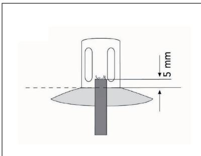
L'apertura dello stoppino deve presentare una tenuta completa. Grazie all'effetto puramente capillare dello stoppino in dotazione, non si brucia e non ha bisogno di essere sostituito.
