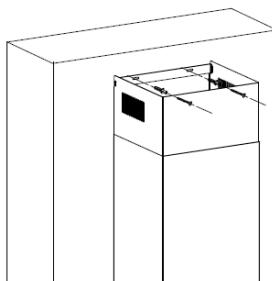
**8** Avvitare il camino superiore con il camino superiore utilizzando 2 viti di tipo ST4x8 mm.
