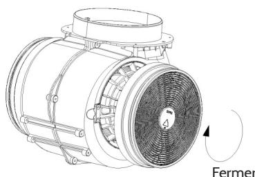
*Remarque : s'assurer que le filtre est bien fixé, sans quoi il pourrait se désolidariser et provoquer un accident. La capacité d'aspiration est légèrement plus faible si un filtre à charbon actif est installé.*
