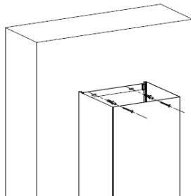
**7** Mettere il camino superiore su quello inferiore. Sollevare il camino superiore per raggiungere l'altezza necessaria. Fissare il camino superiore utilizzando 2 tasselli e 2 viti di tipo ST4X30 mm.
