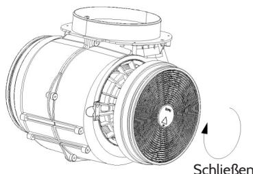
*Hinweis: Achten Sie darauf, dass der Filter fest sitzt. Sonst kann er sich lösen und zu einer Gefahr werden. Bei eingesetztem Filter verringert sich die Ansaugleistung.*
