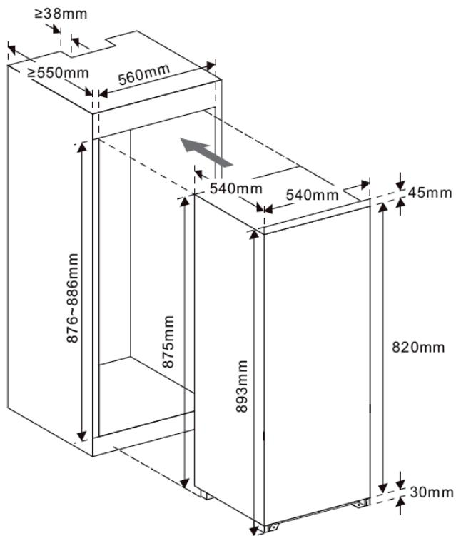
Asegúrese de que el armario empotrado es lo suficientemente grande y proporciona una ventilación adecuada.
