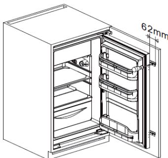
Schieben Sie das Gerät langsam und vorsichtig in den Schrank. Achten Sie darauf, dass die Öffnungsseite so nah wie möglich an der Schrankwand liegt und die Vorderseite mit der Vorderseite des Einbauschrankes bündig abschließt.
