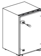
Retirez les 4 vis à l'avant de la porte. Fixez ensuite les deux guides à la porte avec les 4 vis.
