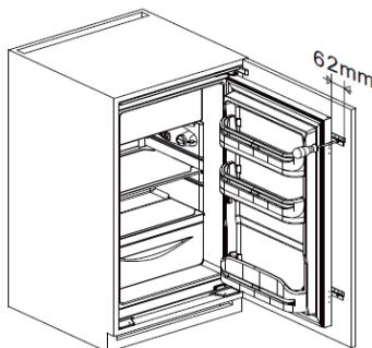
Faites glisser lentement et prudemment l'appareil dans l'armoire. Assurez-vous que l'ouverture est aussi proche que possible de la paroi de l'armoire et que l'avant est aligné avec l'avant de l'armoire encastrée.
