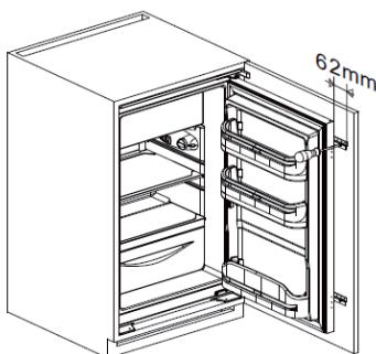
Deslice el aparato lentamente y cuidadosamente en el armario. Asegúrese de que el lado de apertura está lo más cerca posible de la pared del armario y que la parte delantera esté al ras del armario empotrado.
