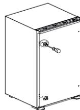
Entfernen Sie die 4 Schrauben vorne an der Tür. Befestigen Sie dann die zwei Führungen mit den 4 Schrauben an der Tür.
