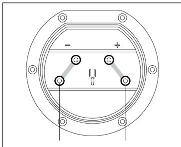
Collegare poi un'estremità del cavo ai due terminali inferiori dell'altoparlante. Quando si collega l'altra estremità all'amplificatore, assicurarsi di collegare il terminale POSITIVO (di solito ROSSO) dell'amplificatore al terminale POSITIVO del pannello di connessione e il terminale NEGATIVO (di solito NERO) a quello NEGATIVO.
