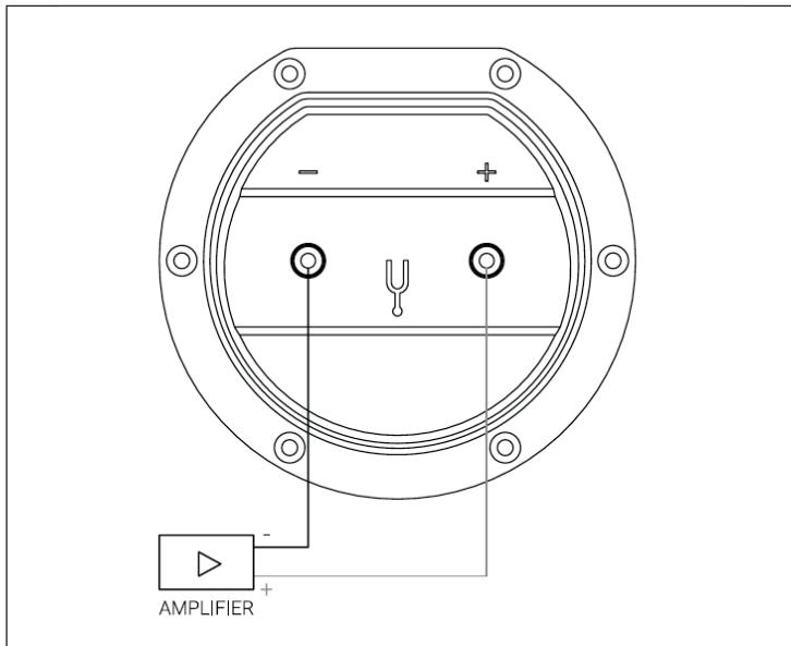
Verbinden Sie bitte zuerst das eine Ende Ihres Kabels mit den beiden Anschlussklemmen an Ihrem Lautsprecher. Wenn Sie dann das andere Ende an den Verstärker anschließen, achten Sie bitte darauf die PLUS-Klemme (meist ROT) des Verstärkers mit der PLUS-Klemme des Anschlussfeldes zu verbinden - und MINUS (meist SCHWARZ) mit MINUS.
