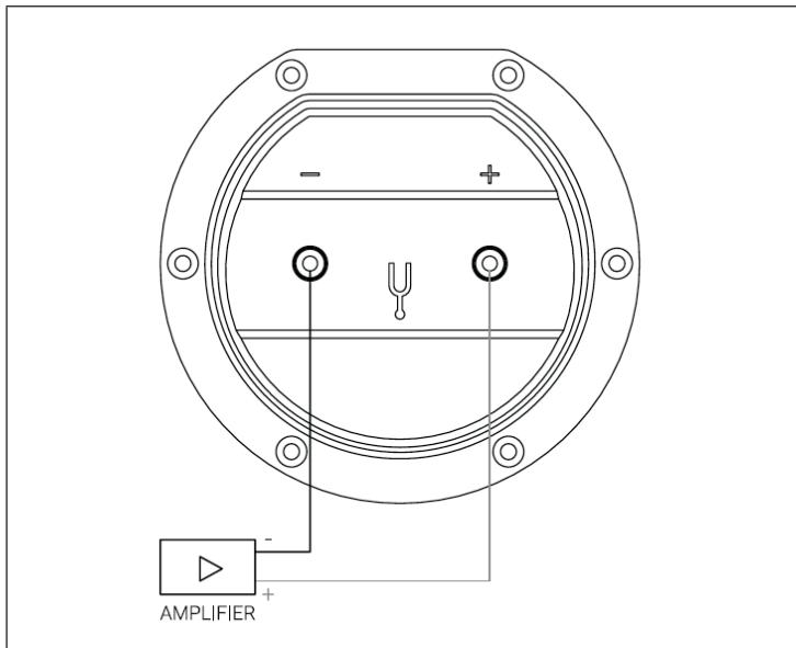
Collegare per prima cosa un'estremità del cavo ai due terminali dell'altoparlante. Quando si collega l'altra estremità all'amplificatore, assicurarsi di collegare il terminale POSITIVO (di solito ROSSO) dell'amplificatore al terminale POSITIVO del pannello di connessione e il terminale NEGATIVO (di solito NERO) a quello NEGATIVO.
