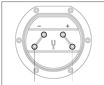
A continuación, conecta un extremo del cable del altavoz a los dos terminales inferiores del mismo. Ahora, cuando conecte el otro extremo al amplificador, asegúrese de conectar el terminal PLUS (normalmente ROJO) del amplificador al terminal PLUS del panel de conexión - y el MINUS (normalmente NEGRO) al MINUS.
