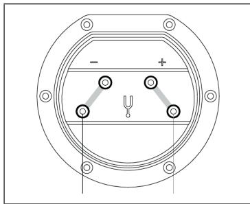
Connectez ensuite l'une des extrémités de votre câble d'enceinte aux deux bornes inférieures de votre enceinte. Si vous connectez maintenant l'autre extrémité à l'amplificateur, veillez à relier la borne PLUS (généralement ROUGE) de l'amplificateur à la borne PLUS du panneau de connexion - et la borne MOINS (généralement NOIRE) à la borne MOINS.
