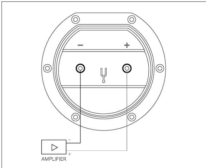
Connectez d'abord l'une des extrémités de votre câble d'enceinte aux deux bornes de votre enceinte. Si vous connectez maintenant l'autre extrémité à l'amplificateur, veillez à relier la borne PLUS (généralement ROUGE) de l'amplificateur à la borne PLUS du panneau de connexion - et la borne MOINS (généralement NOIRE) à la borne MOINS.
