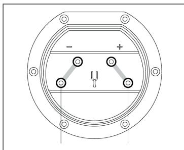
Verbinden Sie dann das eine Ende Ihres Lautsprecherkabels mit den beiden unteren Anschlussklemmen Ihres Lautsprechers. Wenn Sie nun das andere Ende an den Verstärker anschließen, achten Sie darauf, die PLUS-Klemme (meist ROT) des Verstärkers mit der PLUS-Klemme des Anschlussfeldes zu verbinden - und MINUS (meist SCHWARZ) mit der MINUS.
