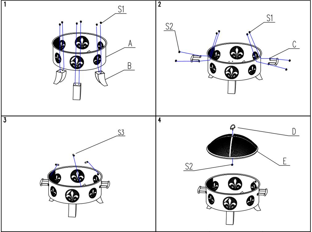
1. Die Beine (B) ansetzen und mit den Schrauben (S1) an der Feuerschale (A) befestigen.
