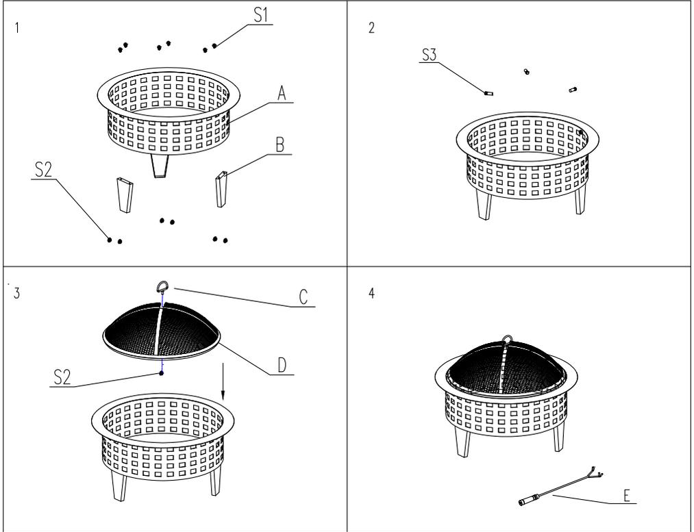
1. Die Beine (B) ansetzen und mit den Schrauben (S1) an der Feuerschale (A) befestigen.
