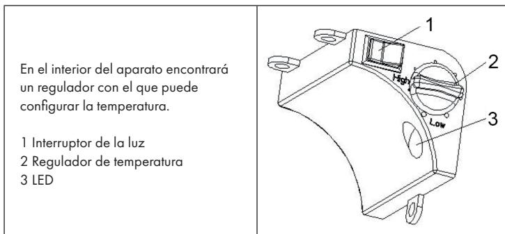
En el interior del aparato encontrará un regulador con el que puede configurar la temperatura.
