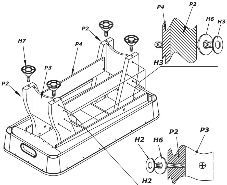
1. Montieren Sie die beiden Endplatten (P3) an die Innenseite der Beine. Benutzen Sie hierfür die  $\frac{1}{4}$ "-Zoll-Schrauben (H2) sowie die Unterlegscheiben H6. (Die Gewinde sind bereits in die Beinstücke eingearbeitet).
