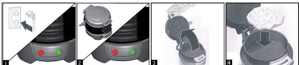
Inserire la spina nella presa. La spia rossa si accende. Far preriscaldare il dispositivo con il coperchio chiuso. La piastra di cottura e l'anello devono essere inseriti. La spia verde si accende appena il dispositivo si è preriscaldato. La spia verde si accende e si spegne di frequente quando il dispositivo è in funzione. La spia verde NON indica che il sandwich è pronto. La spia rossa resta accesa mentre il dispositivo è in funzione.
