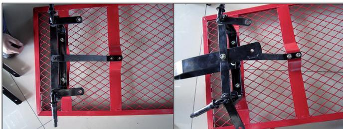
4. Setzen Sie den Lenkanschluss (12) auf die vordere Achshalterung (10).
