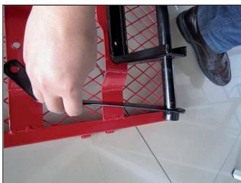
4. Mettere in corrispondenza i fori sulle estremità piatte del lato sinistro della guida dell'asse posteriore (9) con i fori sul fondo (1). Inserire le viti (16) dal lato inferiore del fondo nei fori in corrispondenza. Mettere una rondella (16) sulle viti e avvitare un dado (16) sopra a ognuna.
