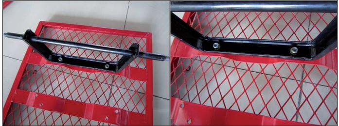
3. Setzen Sie das linke Ende der hinteren Achsführung (9) auf die linke Seite der hinteren Achshalterung (8) mit den angeschweißten Distanzhülsen nach außen. Wiederholen Sie diesen Schritt für die rechte Seite.
