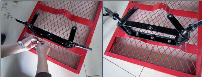
2. Coloque el yugo (13) sobre el soporte del eje frontal (10) pasando el tornillo del yugo a través de los orificios del soporte del eje frontal (10).
