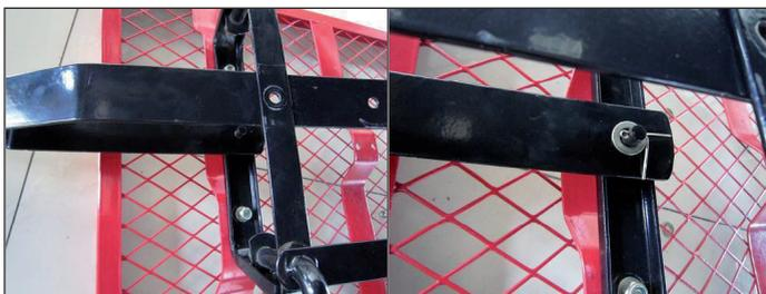
3. Posicione un extremo del guía del eje central (11) sobre la base (1) y el otro extremo sobre el soporte del eje frontal (10). Alinee los orificios del soporte del eje frontal (10), el guía del eje central (frontal) y el yugo (13) y pase los tornillos M8x25 desde abajo. Enrosque las arandelas y las tuercas M8 (17) en los tornillos M8. Monte el otro extremo con los 2 juegos de los tornillos M8x18, arandelas M8 y tuercas (16).
