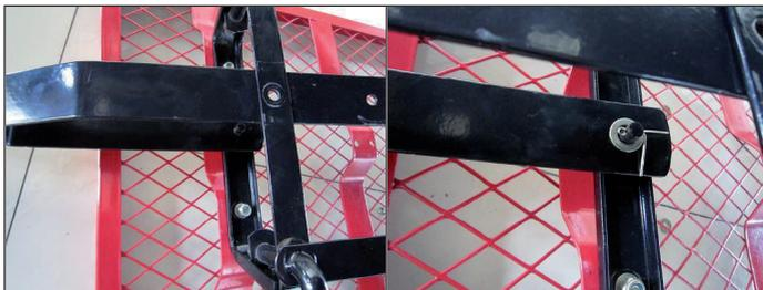
3. Placez une extrémité du guide d'essieu central (11) sur le plancher (1) et l'autre extrémité sur le support d'essieu avant (10). Alignez les trous du support d'essieu avant (10), du guide d'essieu central (avant) et de la fourche (13) et insérez les vis M8x25 par le bas. Placez les rondelles sur les filetages de la vis (M8) et fixez les écrous M8 (17) dessus. Montez l'autre extrémité avec 2 jeux de vis M8x18, rondelles M8 et écrous (16).
