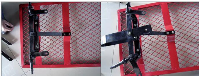
4. Posizionare il collegamento di sterzata (12) sul supporto dell'asse anteriore (10). Mettere in corrispondenza i fori e fissare i componenti con 3 set di viti M8x18, rondelle M8 e dadi (16).
