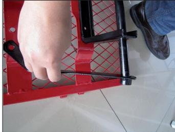
4. Richten Sie die Bohrungen an den flachen Enden der linken Seite der hinteren Achsführung (9) mit den Bohrungen am Boden (1) aus. Führen Sie die Schrauben (16) von der Unterseite des Bodens in die bündig ausgerichteten Bohrungen. Legen Sie eine Unterlegscheibe (16) über die Schrauben und schrauben Sie jeweils eine Mutter (16) rauf.
