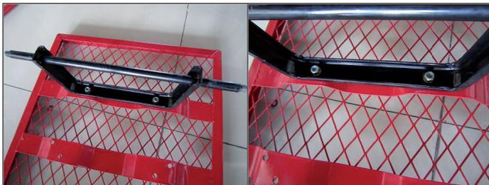
3. Placez l'extrémité gauche du guide d'essieu arrière (9) sur le côté gauche du support d'essieu arrière (8) avec les entretoises soudées vers l'extérieur. Répétez cette étape pour le côté droit..
