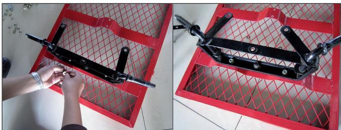
2. Posizionare la forcella (13) sul supporto dell'asse anteriore (10), facendo passare le viti della forcella attraverso i fori sul supporto dell'asse (10).
