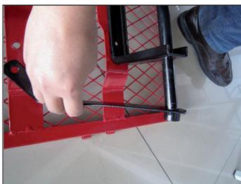
4. Alignez les trous sur les extrémités plates du côté gauche du guide d'essieu arrière (9) avec les trous en bas (1). Insérez les vis (16) du dessous du plancher dans les trous affleurant. Placez une rondelle (16) et vissez un écrou (16) sur chaque vis.
