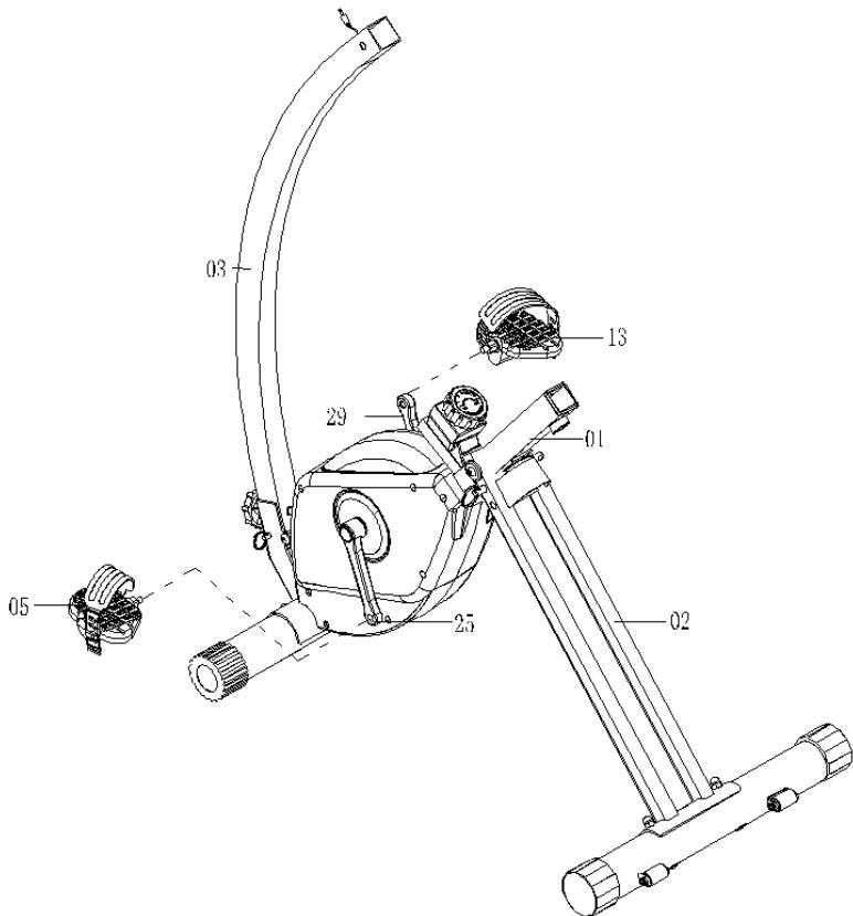
Montieren Sie die Pedale (05) & (13) an den entsprechend gekennzeichneten Kurbeln (L/R für Rechts/Links).
