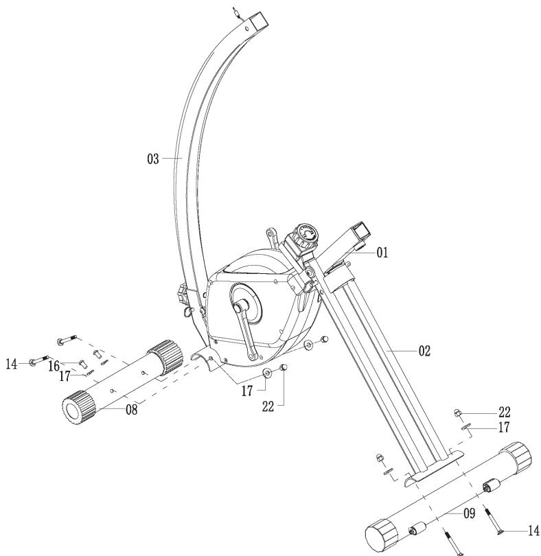
Montieren Sie den vorderen Fuß (8) am Hauptteil (1) und verschrauben Sie mit zwei Sets Schlossschrauben (14) mit Hutmuttern (22) und Bogenscheiben (17). Ziehen Sie die Schrauben NOCH NICHT FEST AN.
