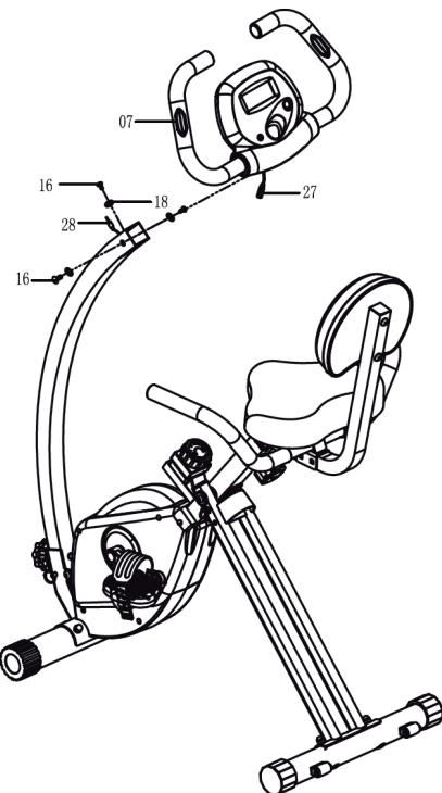
Conecta los extremos del cable del sensor (27 + 28).
