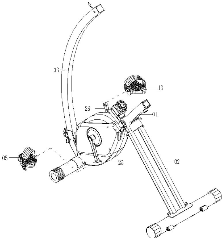
Ajuste los pedales (05) y (13) a las manivelas (L/R para derecha/izquierda) marcadas para ello.
