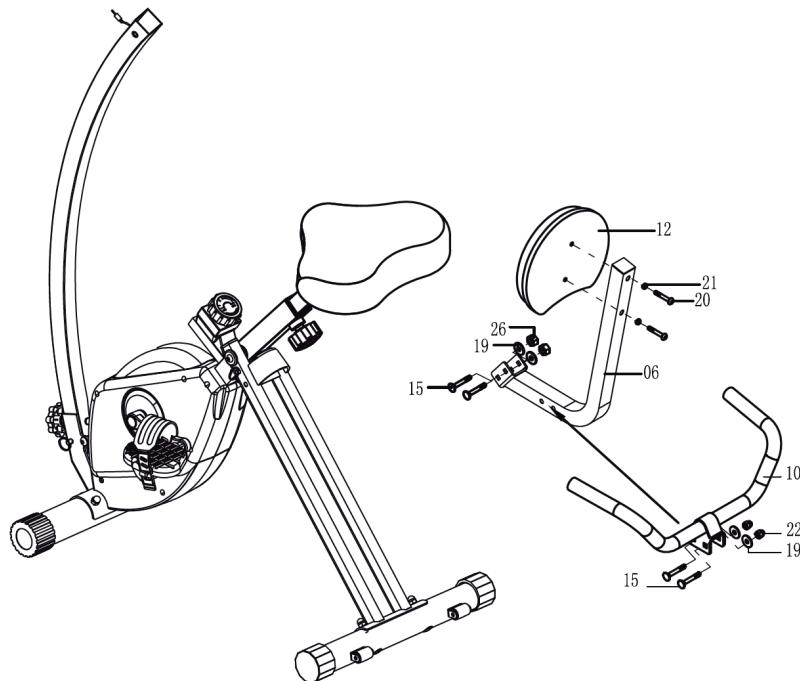
Montieren Sie die Säule (6) an der Sattelstütze (4) und verschrauben Sie mit zwei Sets Schlossschrauben (15) mit Unterlegscheiben (19) und Muttern (26).
