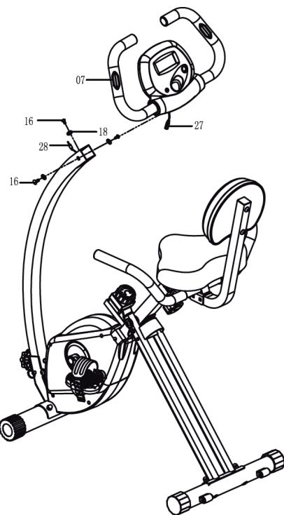
Connectez les extrémités du câble du capteur (27 + 28) ensemble.
