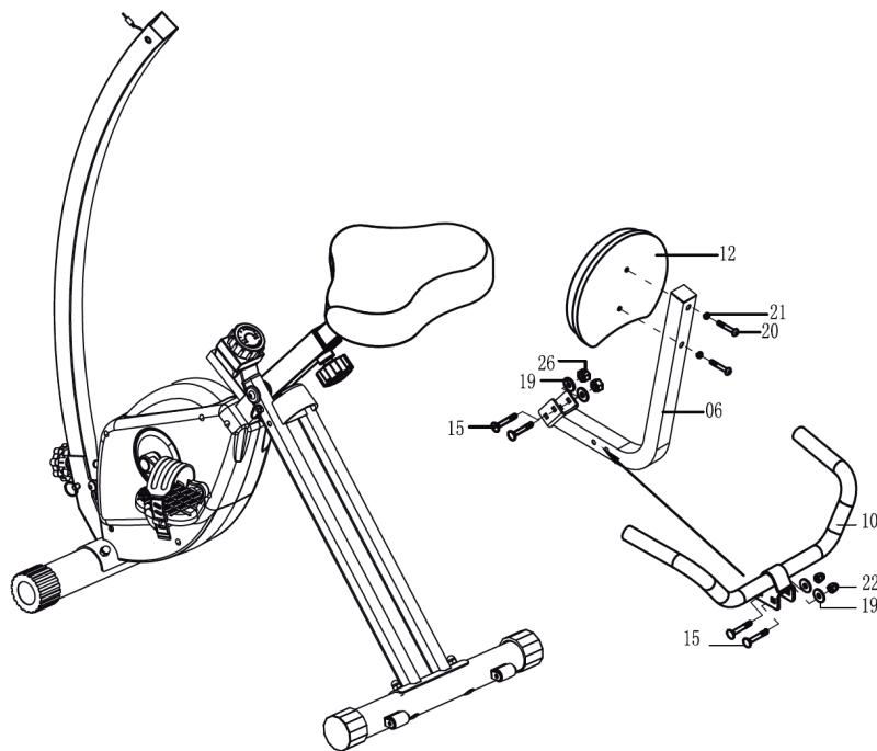
Placez le montant (6) sur la tige de selle (4) et vissez-la avec deux jeux de vis à têtes bombées (15) avec rondelles (19) et écrous (26).
