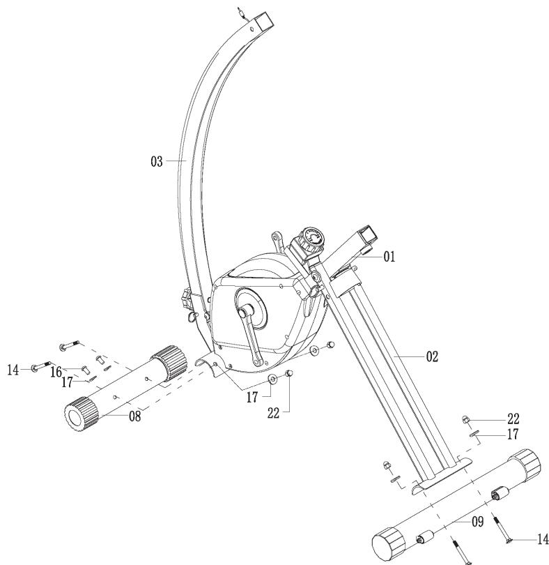
Monte la pata delantera (8) en la parte principal (1) y atorníllela con dos juegos de tornillos de coche (14) con tuercas de sombrero (22) y arandelas curvas (17). NO APRIETE los tornillos.
