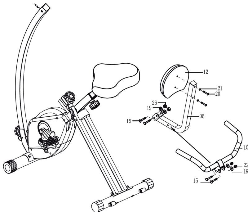
Montare la colonna (6) al supporto della sella (4) e avvitare con due set di viti di bloccaggio (15) con rondelle (19) e dadi (26).
