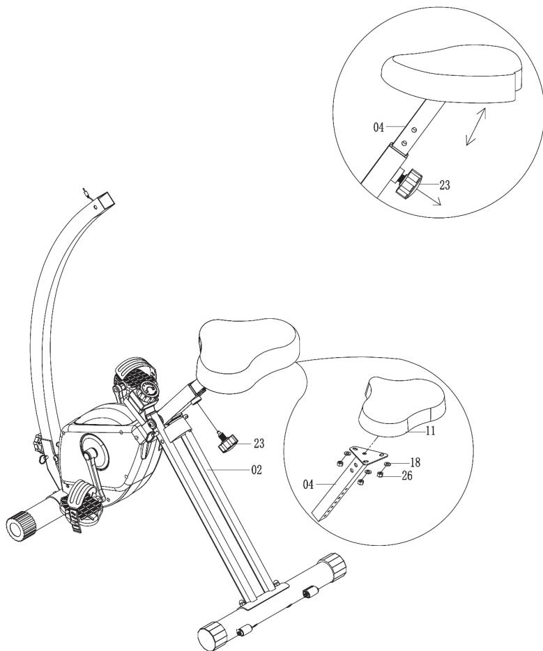
Retirez les écrous et rondelles en plastique (26 + 18) de la face inférieure du siège.
