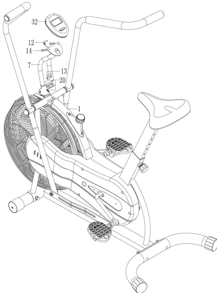
Conecte los dos extremos del cable del sensor (12 + 20).
