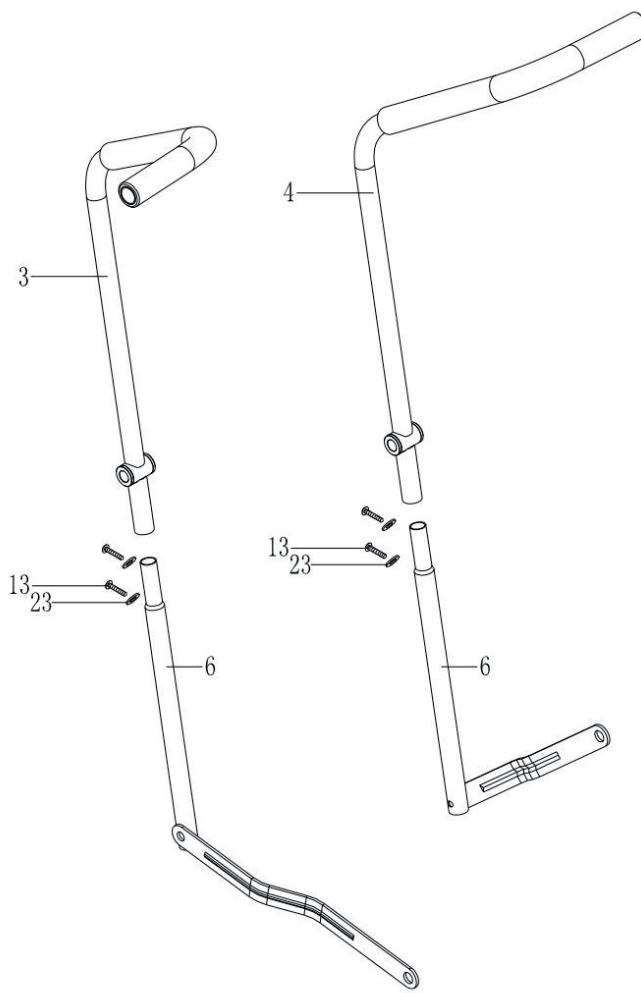
Assemblez les parties supérieure et inférieure du guidon (3 / 4 et 6). Vissez-les ensemble avec deux vis à tête hexagonale (13) et des rondelles bombées (23).
