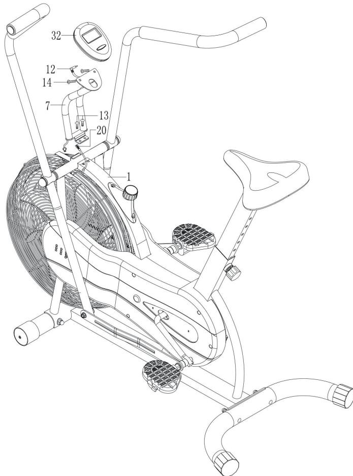
Connectez ensemble les deux extrémités du câble du capteur (12 + 20).
