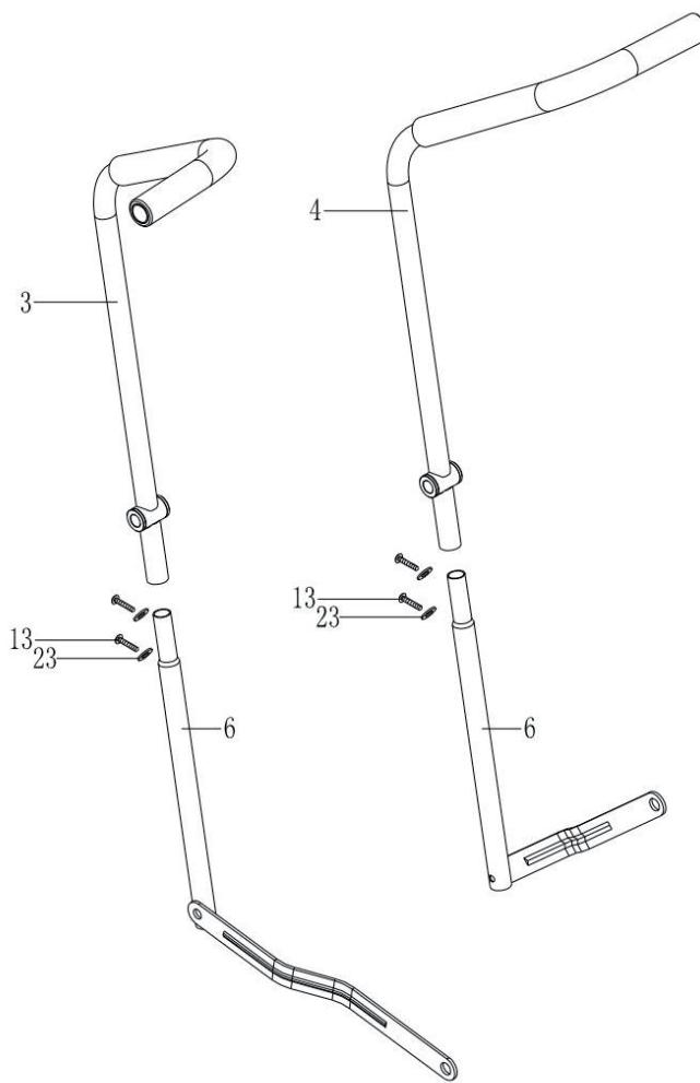
Coloque las partes superior e inferior del manillar (3 / 4 y 6). Atornille con dos tornillos de cabeza hexagonal (13) y arandelas arqueadas (23) cada uno.
