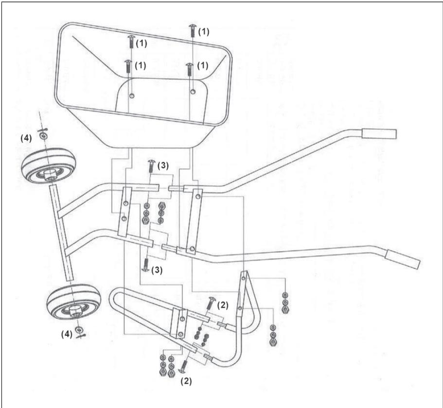
**Hinweis:** Schrauben Sie alle Schrauben während des Aufbaus zunächst locker an. Ziehen Sie am Ende alle Schrauben fest. Es ist empfehlenswert, diese Schubkarre zu zweit aufzubauen.
