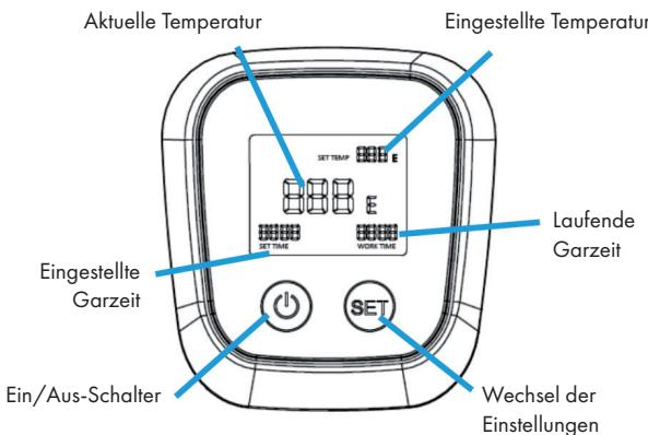
Berühren Sie die Ein/Aus-Taste über 5 Sekunden. In der ersten Zeile erscheint die eingestellte Temperatur. In der zweiten Zeile erscheint die Anzeige der aktuellen Temperatur. Die dritte Zeile zeigt die eingestellte Zeit und die Betriebszeit an. Halten Sie die Tasten EIN/AUS und SET gleichzeitig 2 Sekunden lang gedrückt, um zwischen °C und °F zu wechseln.
