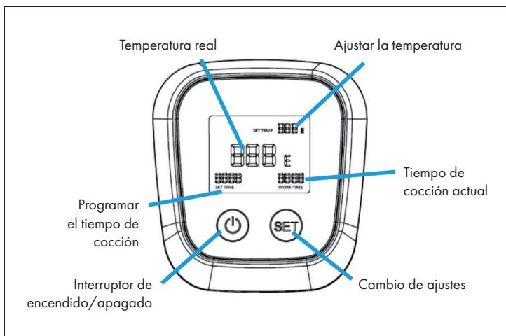
pulse el botón ON/OFF durante 5 segundos. En la primera fila aparecerá la temperatura seleccionada. En la segunda fila aparecerá el indicador de la temperatura actual. La tercera fila muestra el tiempo seleccionado y el tiempo de funcionamiento. Mantenga pulsados los botones ON/OFF y SET durante dos segundos para elegir entre °C y °F.
