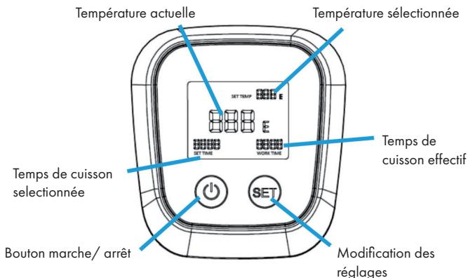
Appuyer sur la touche MARCHE/ARRÊT pendant 5 secondes. La première ligne fait apparaître la température sélectionnée. La deuxième ligne affiche la température réelle actuelle. La troisième ligne indique la durée paramétrée et la durée de fonctionnement. Rester appuyer simultanément sur les touches MARCHE/ARRÊT et SET pendant 2 secondes pour basculer entre °C et °F.
