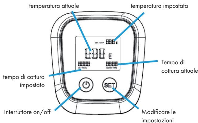
Tenere premuto il tasto ON/OFF per 5 secondi. Nella prima riga compare la temperatura impostata. Nella seconda riga compare la temperatura attuale. La terza riga indica il tempo impostato e il tempo di operatività. Per passare da °C a °F, tenere premuti contemporaneamente per 2 secondi ON/OFF e SET
