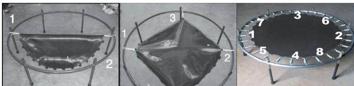
**Suggerimento:** è meglio procedere nel modo mostrato qui - collegare ogni linguetta al telaio. In questo modo si evita di saltare una linguetta e la tensione viene montata in modo uniforme.
