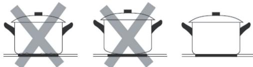
Kochgeschirr, welches aus den folgenden Materialien hergestellt wurde, ist nicht geeignet: reines Edelstahl, Aluminium oder Kupfer ohne magnetische Unterseite, Glas, Holz, Porzellan, Keramik und Töpferware. Verwenden Sie kein Kochgeschirr, welches scharfe Kanten oder eine abgerundete Unterseite aufweist.
