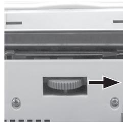
Lösen Sie die Schrauben, die die Abdeckung halten. Lösen Sie die Platte aus dem Einzugschacht, der nach unten ragt.
