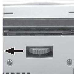
Drehen Sie das Rad nach rechts, um die Breite des Einzugschlitzes zu reduzieren. Wenn das Problem nicht durch die Einstellung über das Rad behoben werden kann, tauschen Sie die Gummilaschen aus.
