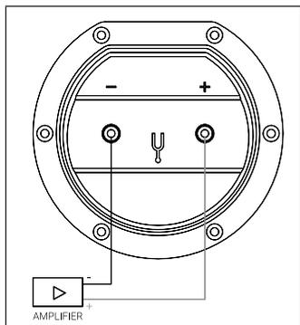
Collegare per prima cosa un'estremità del cavo ai due terminali dell'altoparlante. Quando si collega l'altra estremità all'amplificatore, assicurarsi di collegare il terminale POSITIVO (di solito ROSSO) dell'amplificatore al terminale POSITIVO del pannello di connessione del diffusore Retrospective e il terminale NEGATIVO (di solito NERO) a quello NEGATIVO.
