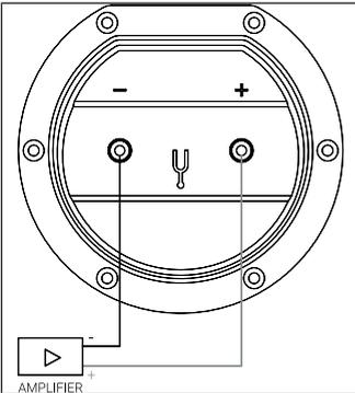
Verbinden Sie bitte zuerst das eine Ende Ihres Kabels mit den beiden Anschlussklemmen an Ihrem Lautsprecher. Wenn Sie dann das andere Ende an den Verstärker anschließen, achten Sie bitte darauf die PLUS-Klemme (meist ROT) des Verstärkers mit der PLUS-Klemme des Retrospective-Anschlussfelds zu verbinden - und MINUS (meist SCHWARZ) mit MINUS.
