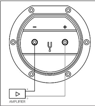
En primer lugar, conecta un extremo del cable a los dos terminales del altavoz. Cuando conecte el otro extremo al amplificador, asegúrese de conectar el terminal PLUS (normalmente ROJO) del amplificador al terminal PLUS del panel de conectores Retrospective - y el MINUS (normalmente NEGRO) al MINUS.
