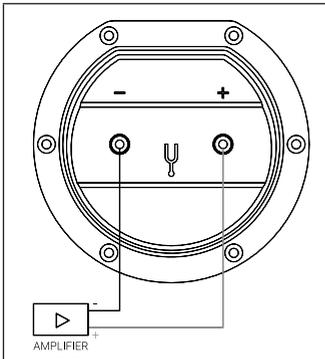
Connectez d'abord l'une des extrémités de votre câble d'enceinte aux deux bornes de votre enceinte. Si vous connectez maintenant l'autre extrémité à l'amplificateur, veillez à relier la borne PLUS (généralement ROUGE) de l'amplificateur à la borne PLUS du panneau de connexion - et la borne MOINS (généralement NOIRE) à la borne MOINS.
