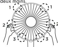
Installation du verrouillage de sécurité (1)
