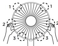
Installation des Schutzverschlusses (1).
