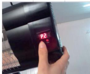
5. Pulse OPEN/CLOSE por cuarta vez para cambiar a la potencia de calefacción alta (Nivel 3- 2000 W). En el display aparece «P3».
