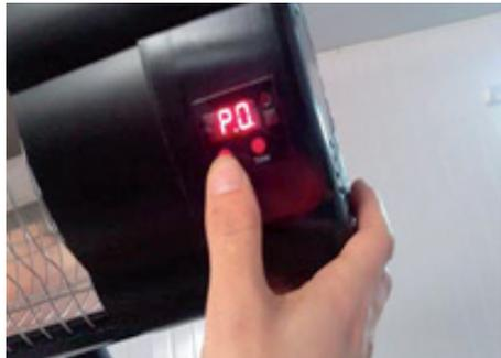
3. Nach einem erneuten Druck auf OPEN/CLOSE erscheint in der Anzeige „P.1“. Das steht für die Heizstufe 1 (850 W).
