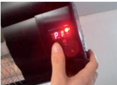
4. Premere OPEN/CLOSE per la terza volta per impostare il livello di riscaldamento medio (livello 2 – 1650 W). Sul display compare "P2".
