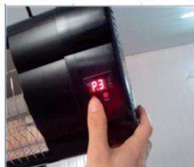
6. Dopo la messa in funzione di riscaldamento, è possibile impostare lo spegnimento automatico da 1 a 24 ore. Sul display digitale compare "0.1" per un'ora, "0.2" per 2 ore ecc.
