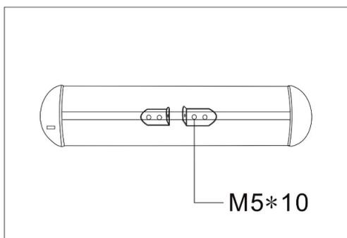
5. Utilisez les éléments de fixation pour accrocher l'appareil sur le pied de support.
