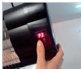
6. Nach der Inbetriebnahme der Heizfunktion, können Sie nach Belieben eine automatische Abschaltung von 1-24 Stunden einstellen. In der Digitalanzeige erscheint „0.1“ für eine Stunde, „0.2“ für zwei Stunden usw.
