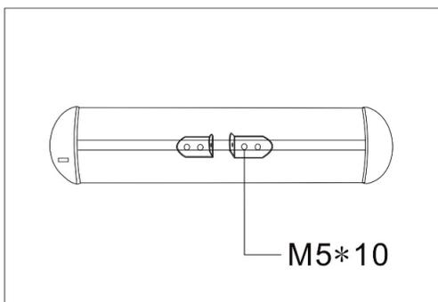
5. Den feststehenden Höcker verwenden, um das Gerät am Ständer zu befestigen.
