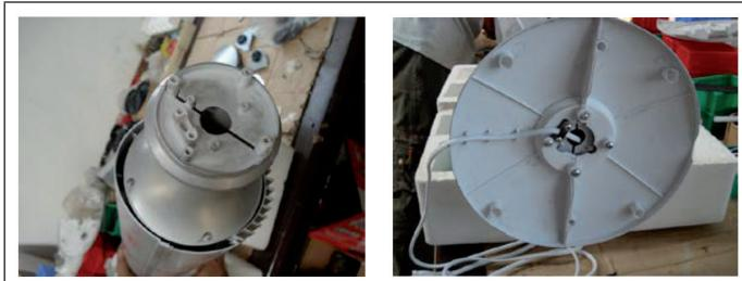
3. Inserte el ventilador a la base y fíjelo atornillando los 3 tornillos largos con el destornillador.
