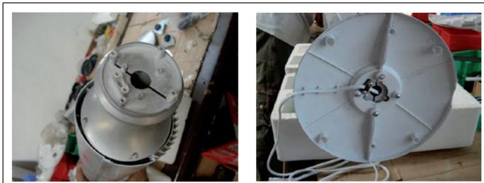
3. Posizionare il ventilatore sulla base e fissarlo stringendo le 3 viti lunghe con il cacciavite.
