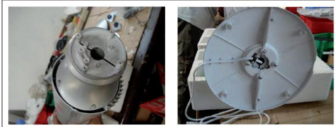
3. Setzen Sie den Ventilator auf die Basis und befestigen Sie ihn, indem Sie die 3 langen Schrauben mit dem Schraubenzieher festziehen.
