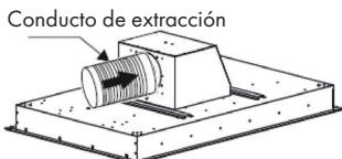
Fije el conducto de extracción a la salida de aire.
