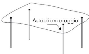
Fissare al soffitto le aste di ancoraggio lunghe 1 metro.
