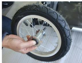
Befestigen Sie das Rad. Drücken Sie auf die Kappe an der Radnabe und drücken Sie das Rad in die Achse, bis es einrastet. Kontrollieren Sie, ob das Rad fest sitzt.
