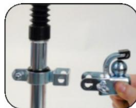
Montage der Kupplung an die Sattelstütze
