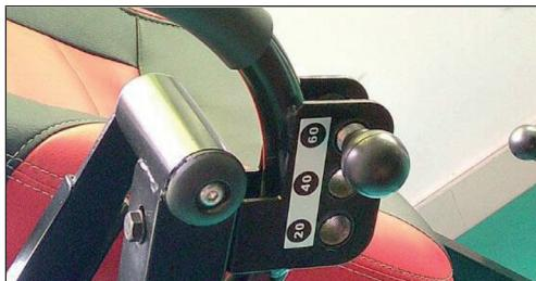
Familiarizzare con la regolazione rapida sul lato destro. La posizione del perno di bloccaggio determina l'angolo di inversione più confortevole. Le 3 impostazioni sono:
