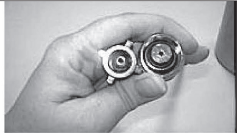
Joint torique sur la conduite de CO 2
