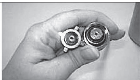
Juntas tóricas en el conducto de CO2
