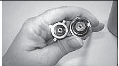
Joint torique sur la conduite de CO 2
