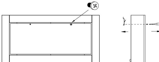
**2 Perfore dos orificios y monte el soporte (disposición horizontal)**
