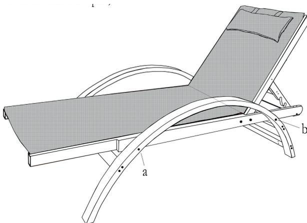
Die Teile L, B und C mit 2 Schrauben (a) und 2 Gegenschrauben (i) verbinden.
