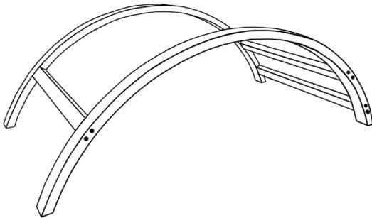
Die Teile L und M mit 12 Schrauben (d) verbinden.
