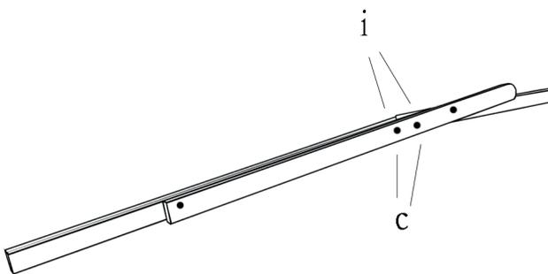
Verbinden Sie die Teile B, C und D. Verwenden Sie 4 Schrauben (c) mit 4 Gegenstücken (i).
