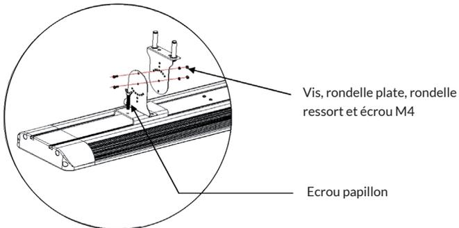
Connectez les deux équerres de réglage et serrez le support avec la vis papillon.
