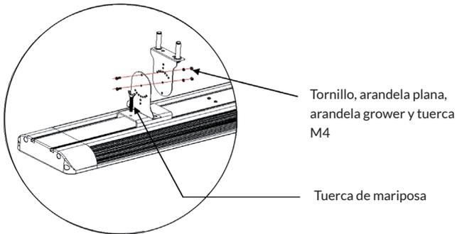
Conecte los dos ángulos de ajuste y apriete la sujeción deslizante con la tuerca de mariposa.
