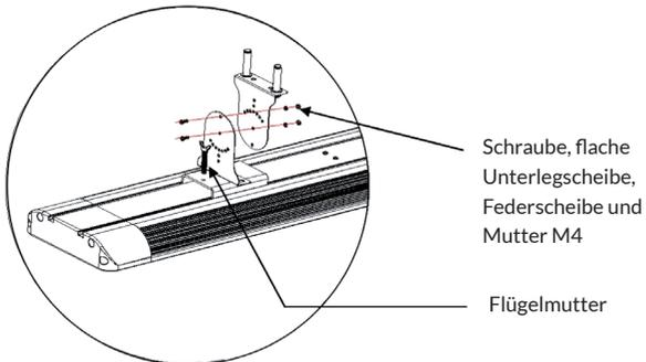
Verbinden Sie die zwei Verstellwinkel und ziehen Sie sie den Schiebebügel mit der Flügelschraube fest.
