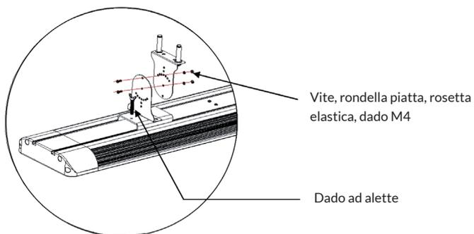
Collegare i due angolari di posizionamento e fissare la guida di scorrimento con la vite ad alette.
