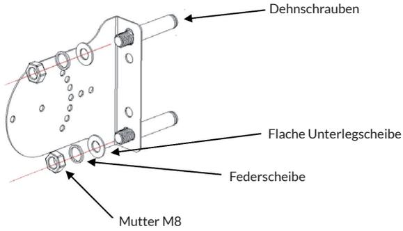
Befestigen Sie die Justierbügel an der Wand.
