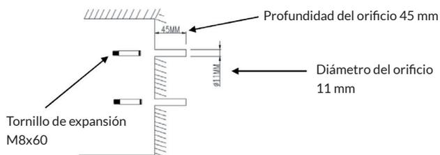
Realice 4 orificios en la pared y coloque 4 tornillos de expansión en la dirección de las flechas.
