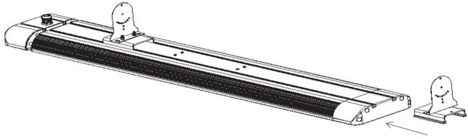
Montare la guida di scorrimento sul radiatore nella direzione della freccia.
