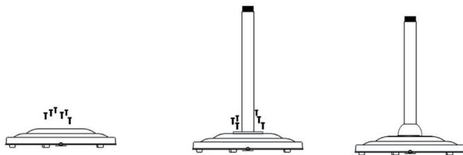
Retirez les six vis M6 \* 30 mm du bas du socle et fixez le tube inférieur sur le socle.
