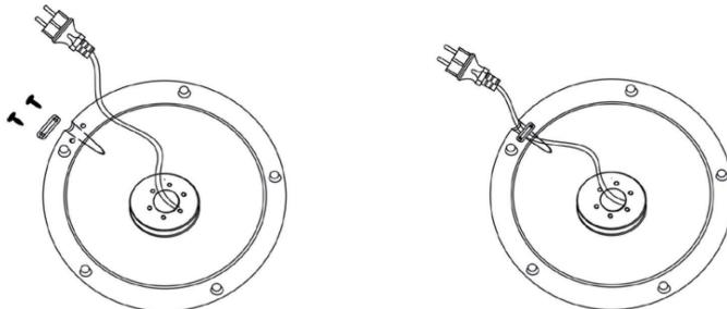
Fije el cable de alimentación al zócalo con dos tornillos ST6x14 mm.
