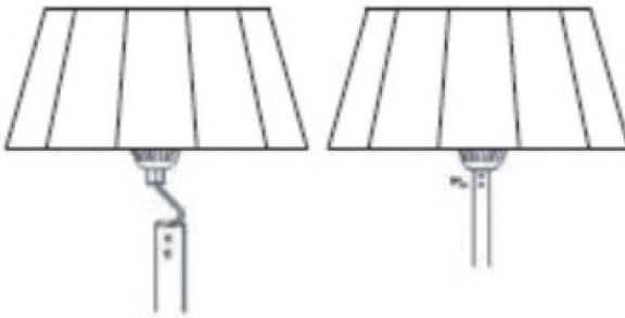
Befestigen Sie den Heizkopf mit zwei ST4\*10 mm Schrauben am Oberrohr.
