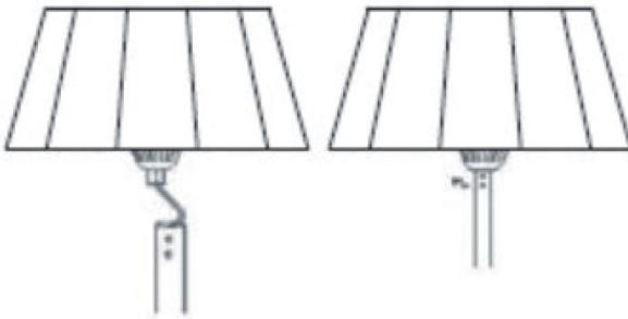
Fixez la tête de chauffage au tube supérieur à l'aide de deux vis ST4 \* 10mm.
