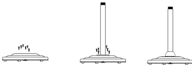
Coja los seis tornillos M6x30 mm situados en el zócalo y fije el conducto inferior al mismo. A continuación, coloque la cubierta decorativa.
