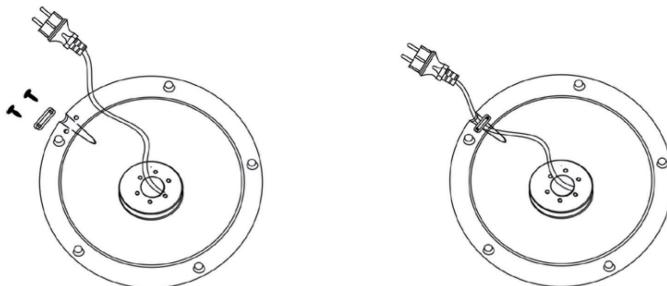
Fixez le câble d'alimentation à la base avec deux vis ST6 \* 14mm.
