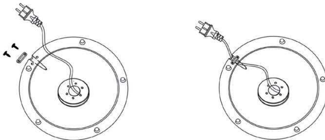
Befestigen Sie das Netzkabel mit zwei ST6\*14 mm Schrauben am Sockel.
