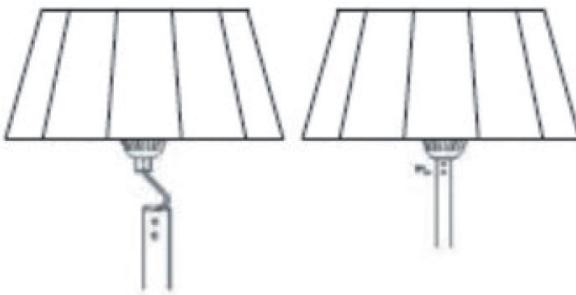
Fixez la tête de chauffage au tube supérieur à l'aide de deux vis ST4 \* 10mm.
