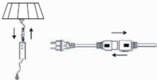
Fissare l'elemento riscaldante al tubo superiore e collegare il cavo di alimentazione al coperchio di plastica.
