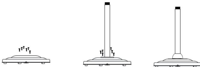
Nehmen Sie die sechs M6\*30 mm Schrauben unten aus dem Sockel und befestigen Sie das untere Rohr am Sockel. Setzen Sie dann die dekorative Abdeckung auf.
