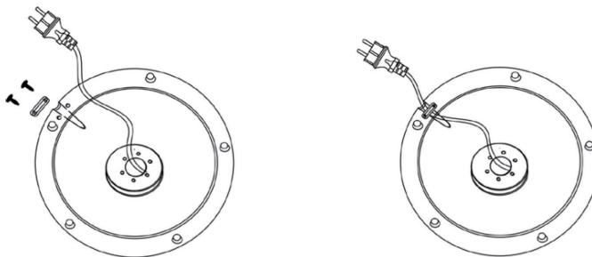
Fissare il cavo di alimentazione alla base utilizzando due viti ST6\*14 mm.
