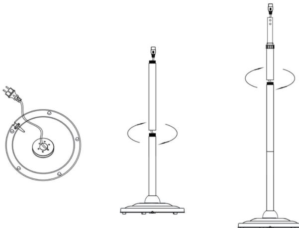
Pase el cable de alimentación por el conducto intermedio y superior y una todos los conductos.
