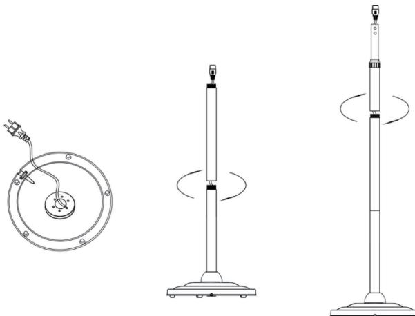
Tirez le câble d'alimentation à travers les tubes central et supérieur et vissez tous les tubes ensemble.
