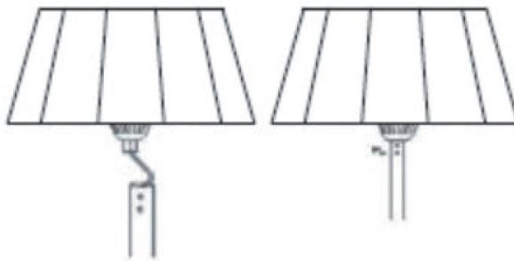
Fissare l'elemento riscaldante al tubo superiore utilizzando due viti ST4\*10 mm.
