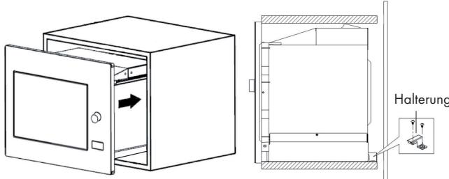
Öffnen Sie die Tür und fixieren Sie die Mikrowelle mit einer Schraube, in den Installationslöchern, am Schrank. Fixieren Sie anschließen die Plastikabdeckung an den Installationslöchern.
