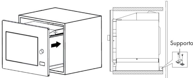
Aprire lo sportello e fissare il microonde al mobile nei fori di installazione utilizzando una vite. Infine fissare il coperchio in plastica ai fori di installazione.
