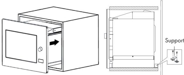
Ouvrez la porte et fixez le micro-ondes sur la niche avec une vis dans les trous d'installation. Puis, fixez le cache en plastique sur les trous d'installation.
