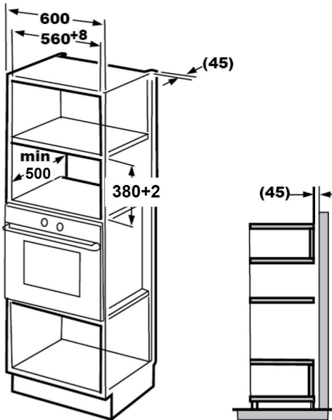
**Remarque :** Le support et le gabarit du bas de l'armoire sont requis pour les deux types d'installation.
