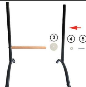
Fixez ensuite le tube de fer (A) sur le tube B (avec le tube en arc déjà installé). Utilisez une vis longue (5) et une petite rondelle en PVC (4). Placez une grande rondelle en PVC (3) entre les tubes avant de serrer. Fixez l'autre côté de la même manière.
