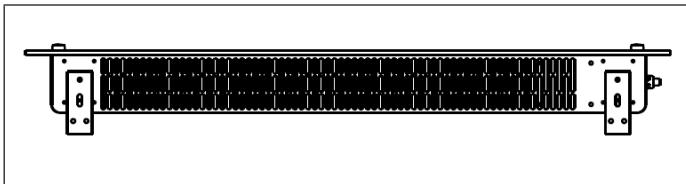
3. Halten Sie das Gerät seitlich. Sehen Sie auf die Position der Bohrungen auf der Gehäuse-Rückseite. Setzen Sie das Gerät auf die Halterungen.
