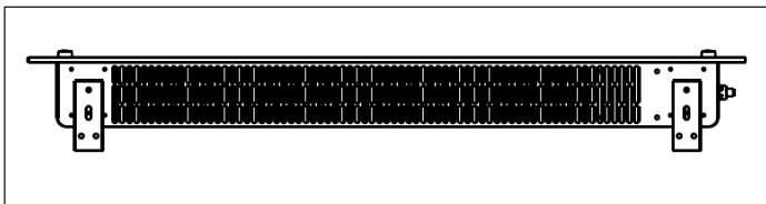
3. Sujete el aparato en el lateral. Mire la posición de los agujeros en el lado trasero de la carcasa. Coloque el aparato sobre los soportes.
