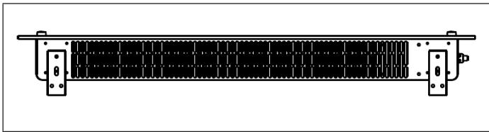
3. Placez l'appareil sur le côté. Repérez la position des trous à l'arrière du boîtier. Posez l'appareil sur les fixations.
