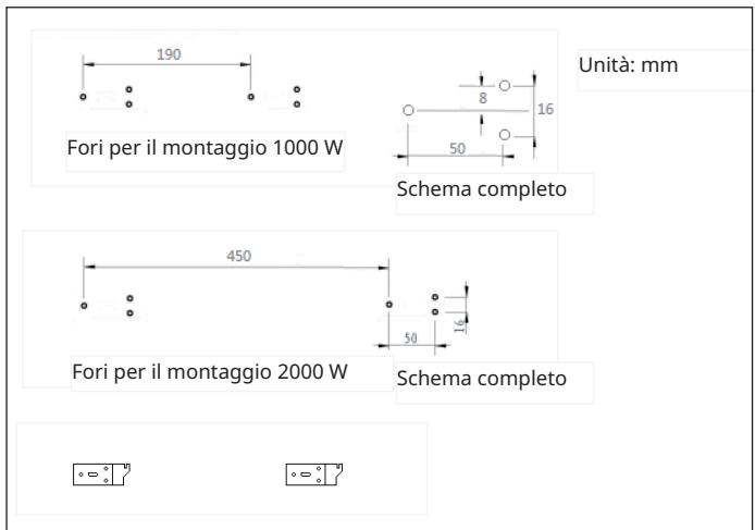
2. Montare 2 supporti sul lato inferiore del dispositivo.
