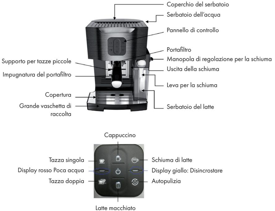
**Avvertenza:** il dispositivo è dotato di una funzione di avviso in caso di acqua insufficiente. Quando il serbatoio dell'acqua è vuoto, suona un allarme, l'indicatore si illumina di rosso e l'unità emette un segnale acustico. Riempire il serbatoio è premere un tasto qualunque per mettere il dispositivo in funzione. La macchina è pronta a riscaldarsi.
