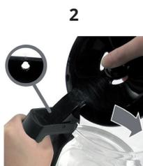
Ruotare il coperchio in direzione della freccia e premere contemporaneamente con la mano sinistra il pin sul manico della caraffa. Staccare il coperchio.
