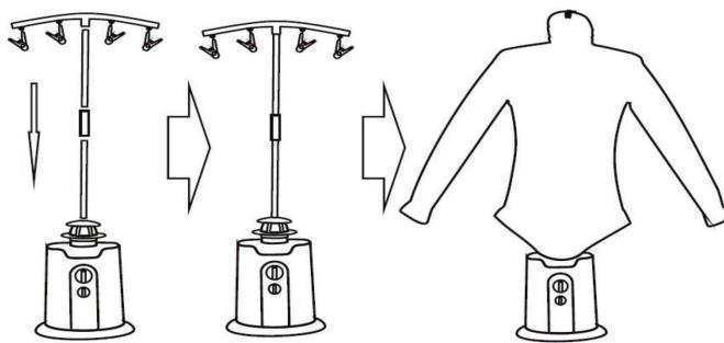
Installare entrambi i tubi di sostegno con i connettori. Posizionare il supporto superiore con le mollette sul tubo di sostegno e chiudere il sacco d'aria.
