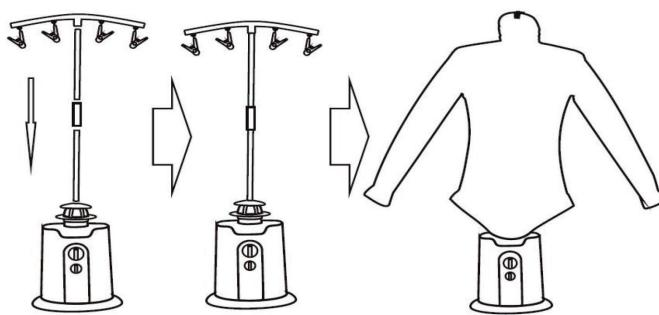
Installieren Sie die beiden Stützrohre mit Hilfe des Verbindungsstücks. Setzen Sie die obere Halterung mit den Clips auf das Stützrohr und schließen Sie den Luftsack..
