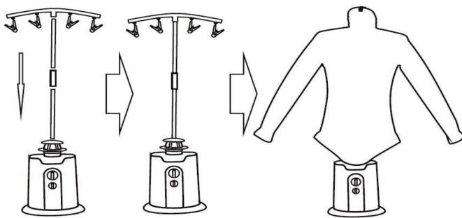
Installez les deux tubes de support en utilisant le connecteur. Placez le support supérieur avec les clips sur le tube de support et fermez le coussin gonflable.
