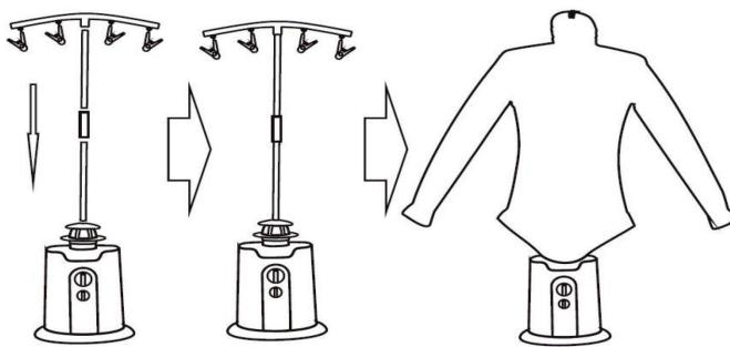
Una las dos barras de soporte con la ayuda de la pieza de unión. Instale el soporte superior con las pinzas y cierre el saco de aire.
