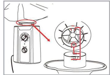
Aprire la cerniera del sacco d'aria e posizionare la copertura sul motore. Fissare l'apertura di uscita dell'aria al motore.
