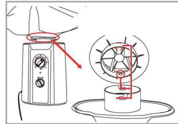
Öffnen Sie den Reißverschluss des Luftsacks und setzen Sie die Abdeckung auf den Motor. Befestigen Sie die Luftauslassöffnung am Motor.
