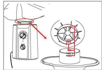
Ouvrez la fermeture à glissière du coussin gonflable et mettez le couvercle sur le moteur. Attachez la sortie d'air au moteur.
