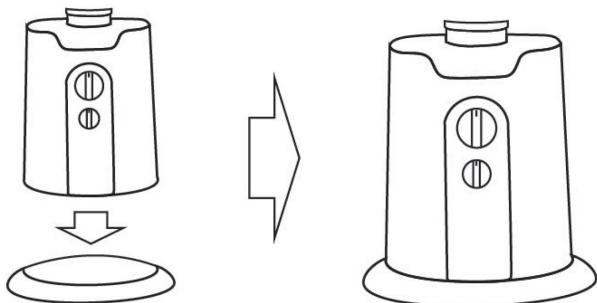
Setzen Sie den Motor auf die Basis.
