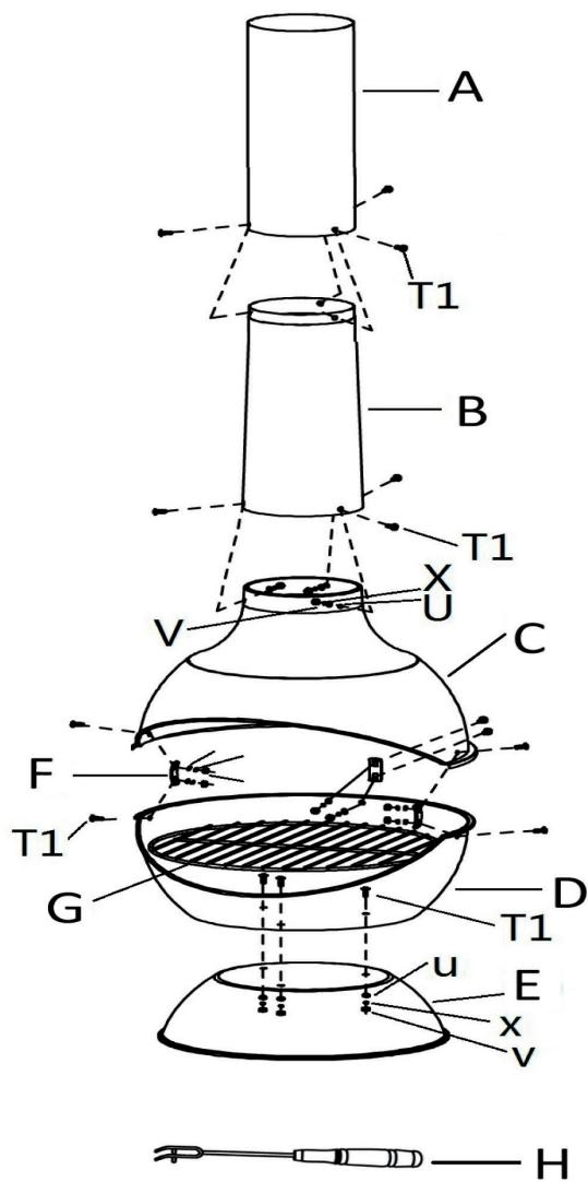
**Remarque :** ne serrez pas les vis avant que l'assemblage ne soit réalisé entièrement. Le montage est plus facile à deux, l'un tenant les pièces et l'autre pour installer les fixations.
