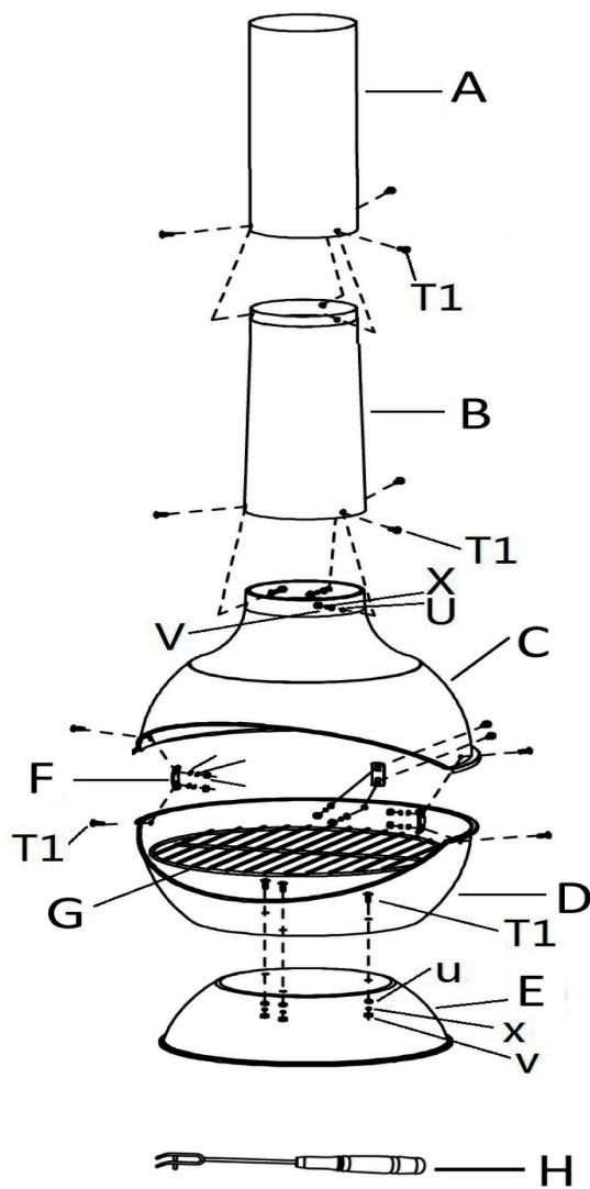
**Hinweis:** Ziehen Sie die Schrauben nicht vollständig An, bevor alle Teile zusammengebaut sind. Die Montage ist einfacher mit zwei Personen, einer zum Halten der Teile und einer zweiten Person zum Einsetzen der Befestigungen.
